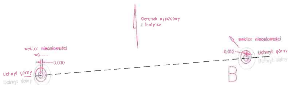
Rys. 2. Pomiar wektorów nieosiowości skrzydeł bramy wjazdowej na dziedziniec wewnętrzny budynku 100.
