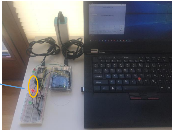
Rysunek 19 Urządzenie zewnętrzne przy komunikacji Bluetooth z zapaloną diodą czerwoną sygnalizującą klasyfikację aktywności myślowej dla K2 „LEFT”
