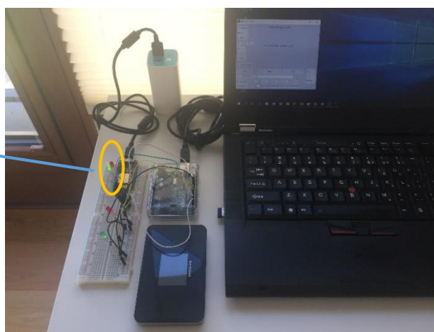
Rysunek 16 Urządzenie z układem NodeMCU podczas komunikacji poprzez Wi-fi przy wyobrażeniu ruchu K3 (dioda zielona włączona)
