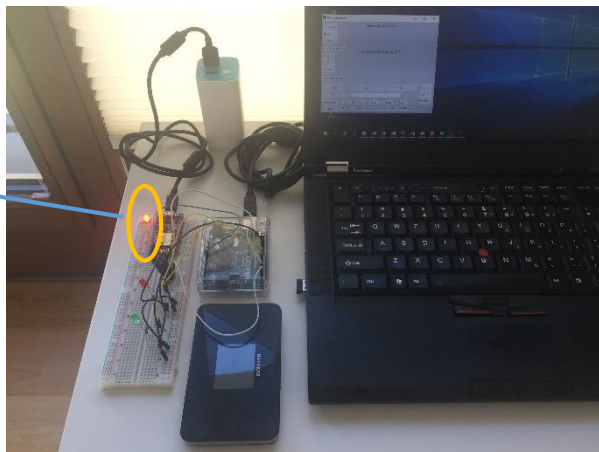
Rysunek 15 Urządzenie z układem NodeMCU podczas komunikacji poprzez Wi-fi przy wyobrażeniu ruchu K2 (dioda czerwona włączona)
