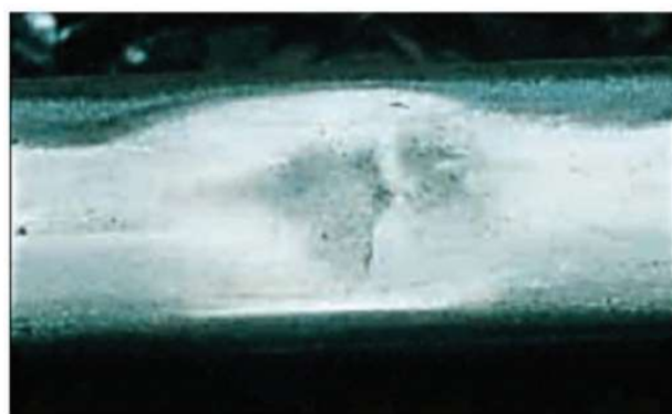
Rys. 1.7 Uszkodzenie szyny typu squat [36].
