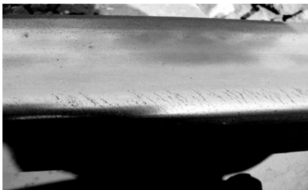
Rys. 1.6 Pęknięcia szyny typu head-check [63].
