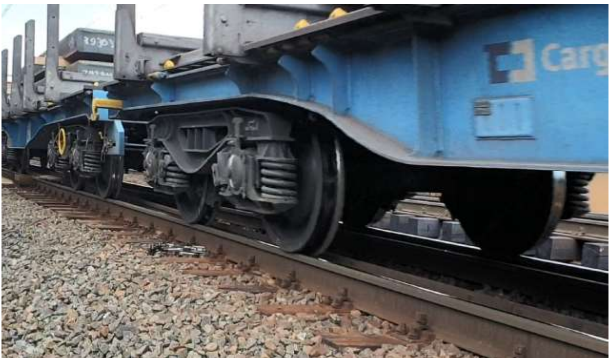
Rys. 4.21 Wiadukt kolejowy w km 88,882 LK nr 272 – pomiar przemieszczenia pionowego szyny obciążonej dynamicznie pociągiem towarowym – fotografia własna.
