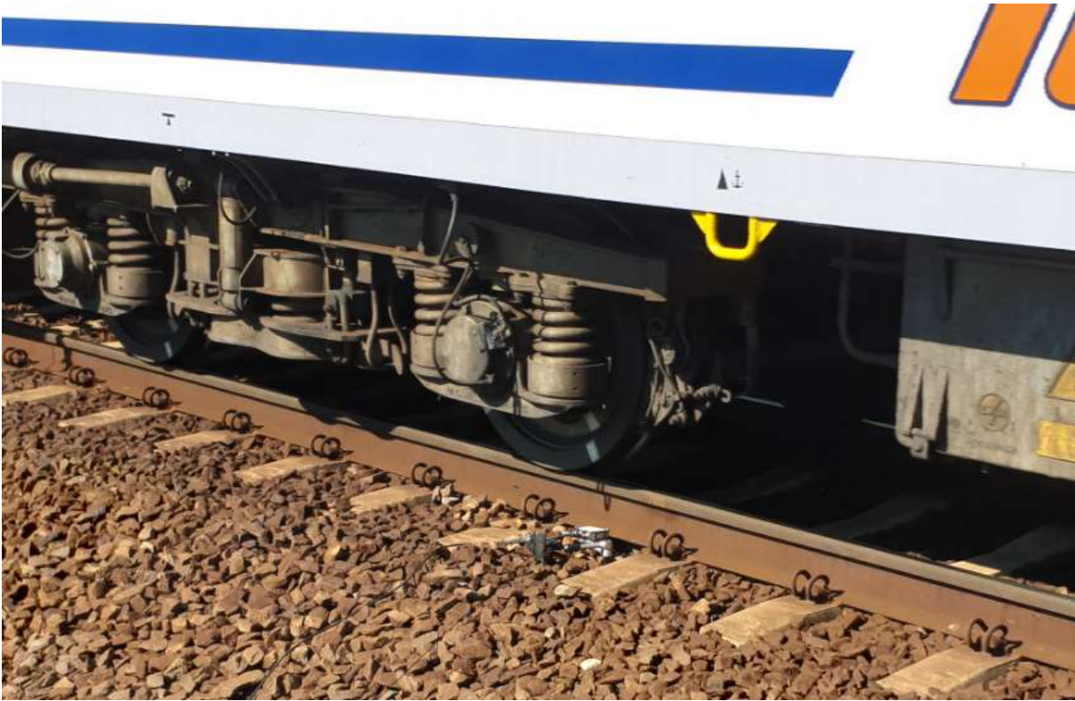
Rys. 4.15 Wiadukt kolejowy w km 83,808 LK nr 272 – pomiar przemieszczenia pionowego szyny obciążonej dynamicznie pociągiem PKP Intercity – fotografia własna.
