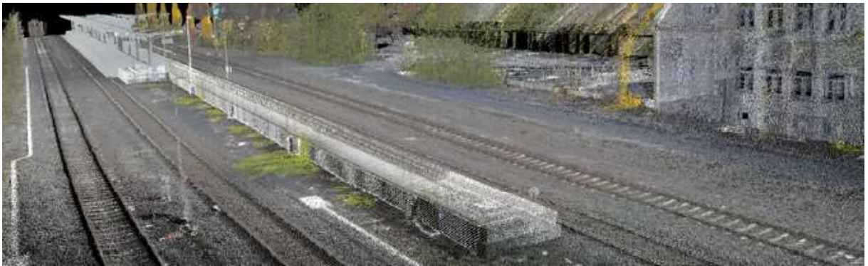
Rys. 4.1 Przykład kolejowej chmury punktów uzyskanej metodą skaningu laserowego [7].
