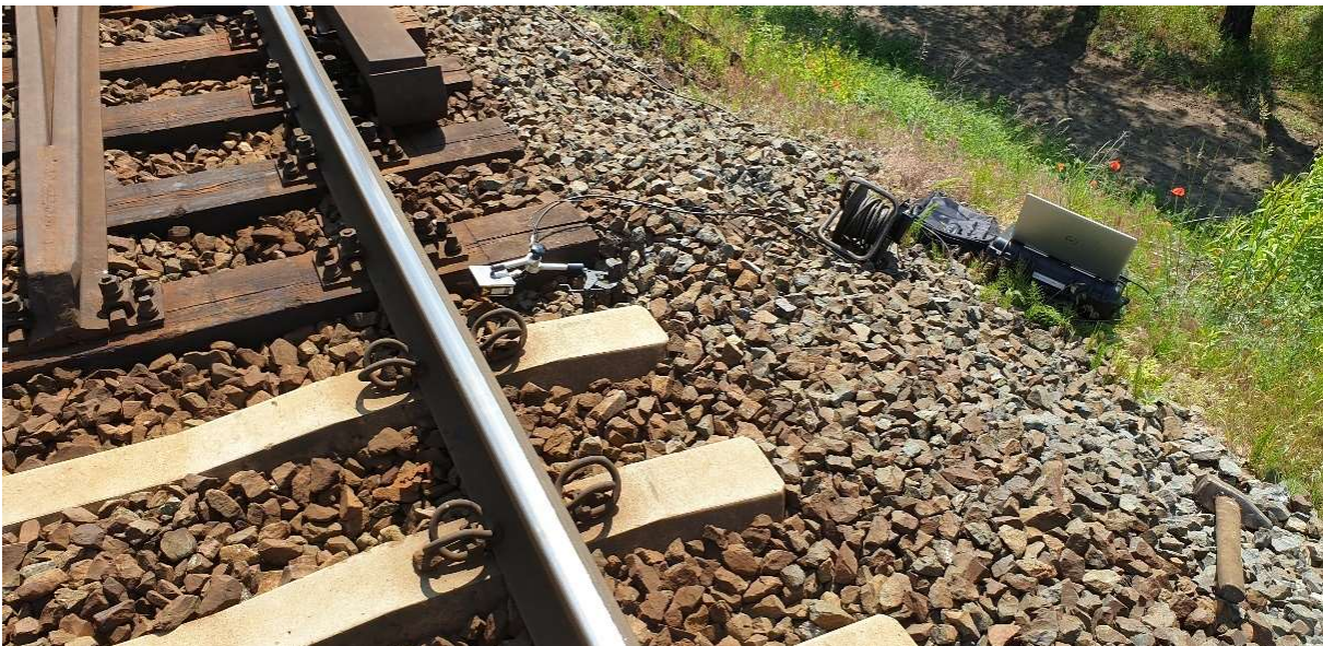
Rys. 4.11 Stanowisko pomiarowe – skokowa zmiana sztywności nawierzchni – dojazd do wiaduktu kolejowego w km 88,882 LK nr 272 – fotografia własna.
