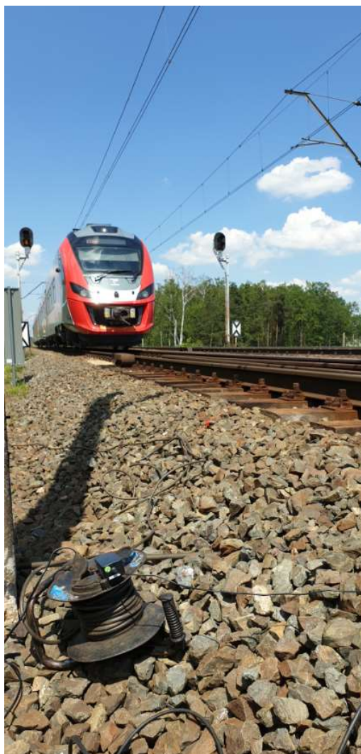
Rys. 4.22 Wiadukt kolejowy w km 88,882 LK nr 272 – pomiar przemieszczenia pionowego szyny obciążonej dynamicznie pociągiem Kolei Wielkopolskich – fotografia własna.
