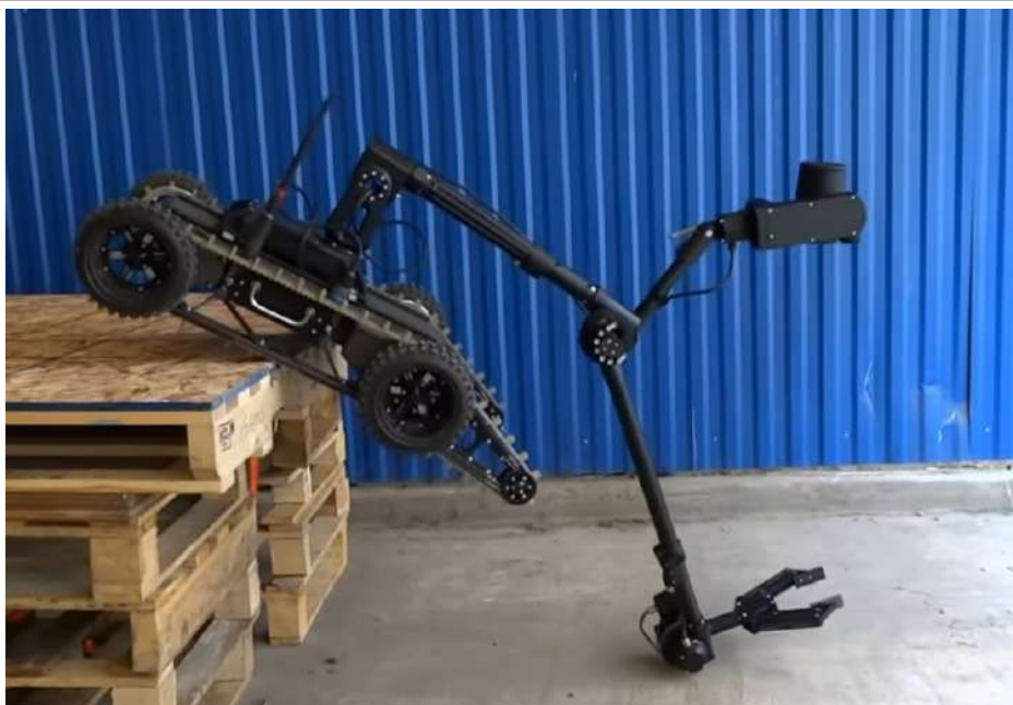
Rys. 5.2. Podparcie robota na kole zamontowanym na przegubie chwytaka
