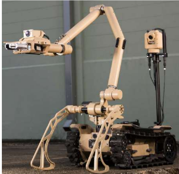
Rys. 2.4. Robot L3Harris T4 wyposażony w podpory zwiększające stateczność robota podczas operowania manipulatorem [13]
