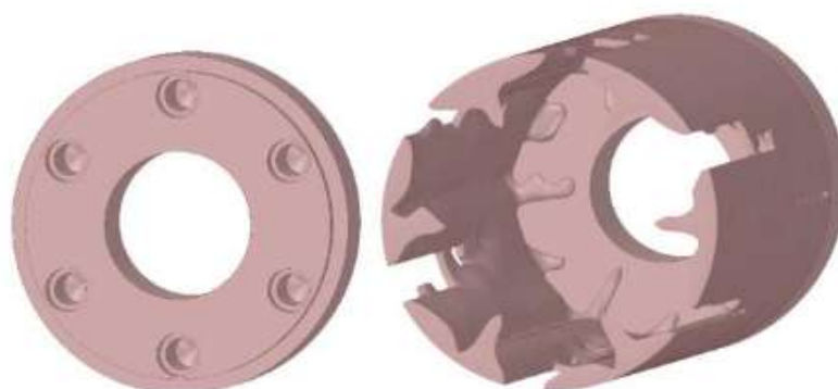
Rys. 3.13. Przykład zastosowania optymalizacji topologicznej do ramienia manipulatora: a - oryginalny komponent ramienia manipulatora (211g), b - nowy komponent ramienia, po optymalizacji topologicznej (139g) ([96])
