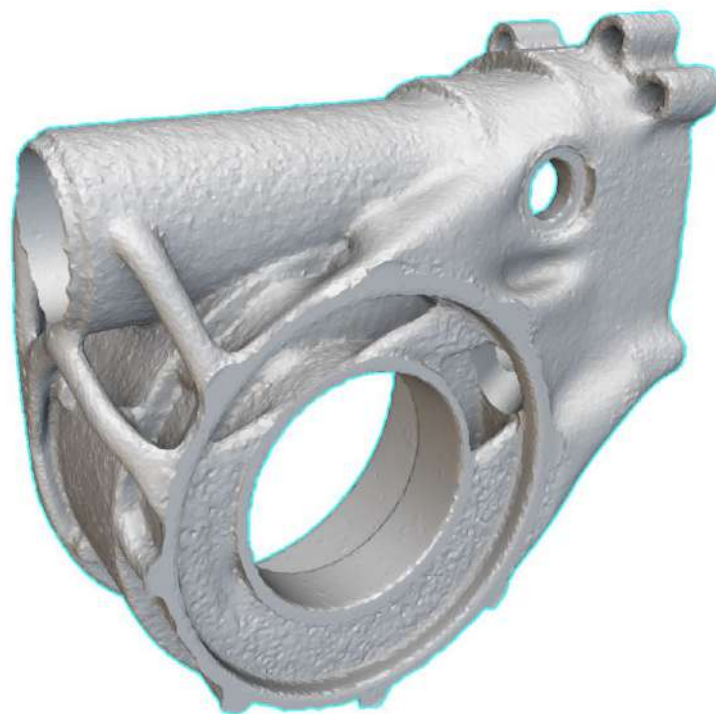
Rys. 8.14. Wynik optymalizacji topologicznej korpusu przegubu manipulatora
