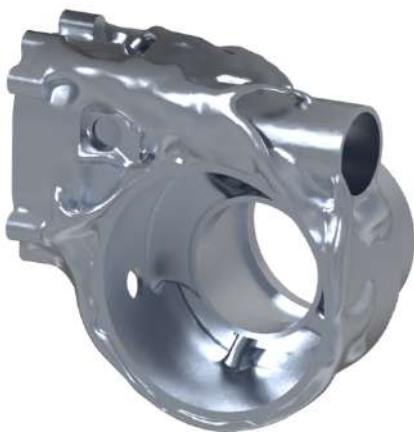
Rys. 7.17. TO bez więzów wykonawczych. Masa wynikowa 401g. Czas obliczeń 42g 7min
