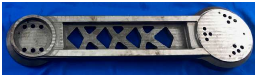
Rys. 3.11. Ramie manipulatora: a - konstrukcja oryginalna, b-konstrukcja po optymalizacji [89].
