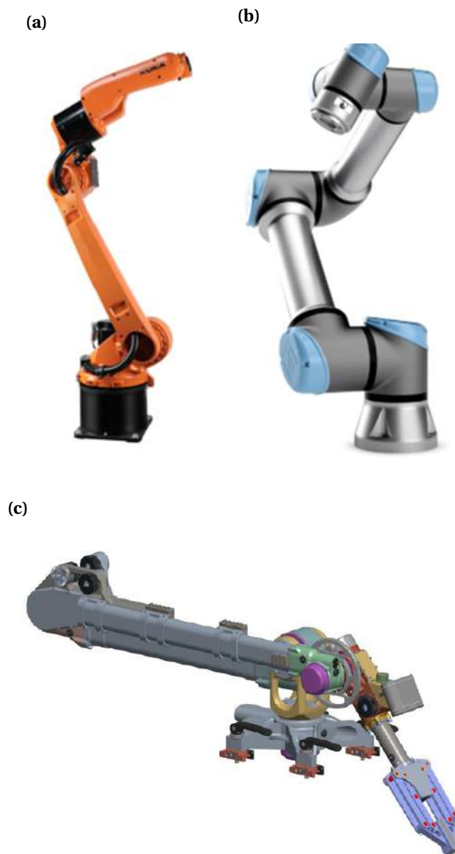
Rys. 3.1. Rodzaje manipulatorów: a- robot przemysłowy Kuka KR16 , b - robot współpracujący Universal Robots UR5e, c - manipulator robota pirotechnicznego z rodziny platform przenośnych Łukasiewicz PIAP
