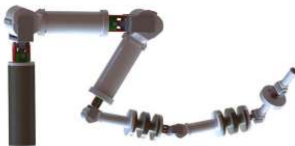
Rys. 3.9. Manipulator o 6 stopniach swobody o parametrach dostosowanych do realizacji zadań w serwerowni. [79]
