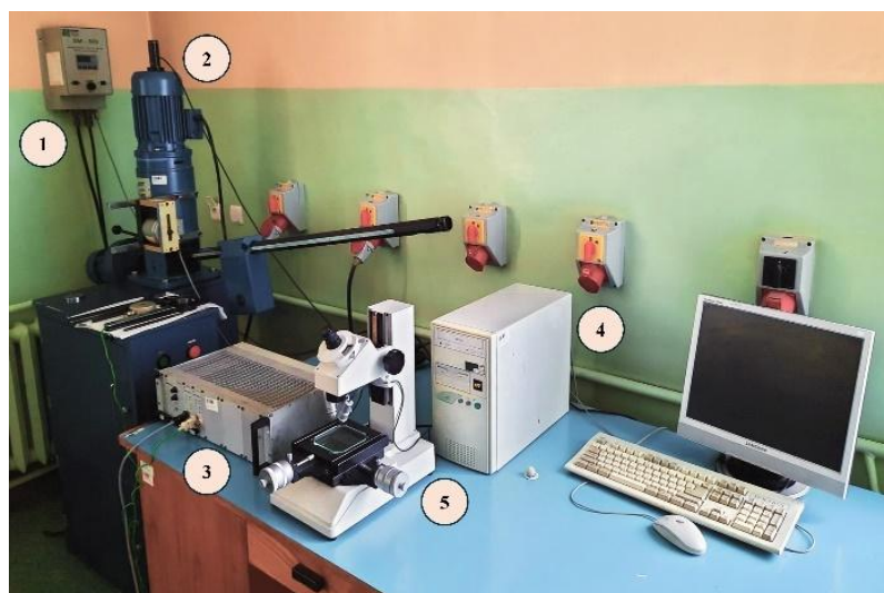
Rys. 4.14. Stanowisko do badań właściwości smarnościowych substancji smarujących: a) aparat czterokulowy T-02 wraz z oprzyrządowaniem: 1 – mikroprocesorowy regulator obrotów silników asynchronicznych SM – 303, 2 – aparat czterokulowy T-02, 3 – mikroprocesorowy sterownik tribologiczny, 4 – komputer sterujący, 5 – mikroskop pomiarowy MP-1
