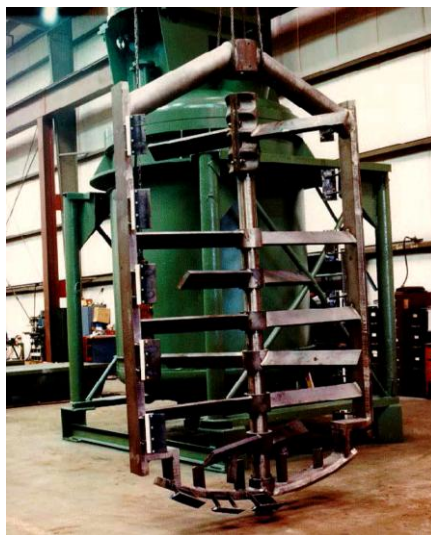
Rys. 1.4. Mieszadło stosowane w procesie wytwarzania smarów plastycznych [84]
