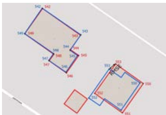
Rys. 3. Półautomatycznie wykryte punkty homologiczne między budynkami OSM (czerwony) a budynkami BDOT10k (niebieski) [źródło: A1, Rys. 5].
