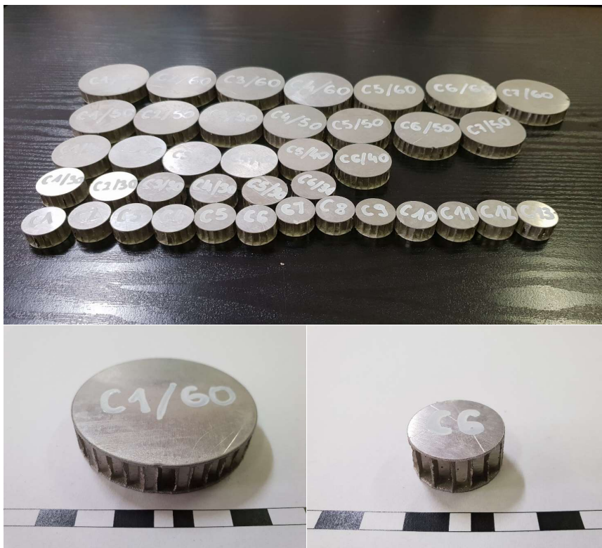
Rys. 4.21 Próbkki z serii 3/16-5052-.001 przygotowane do badań
