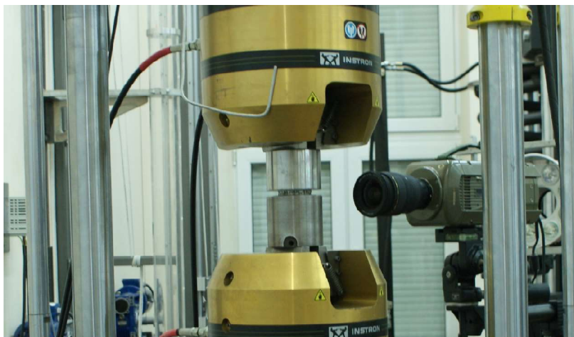
Rys. 4.1 Maszyna wytrzymałościowa INSTRON 8802 wraz z kamerą PHANTOM V12
