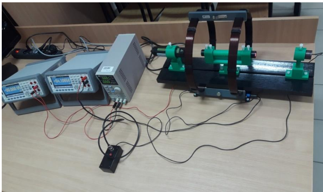
Rys. 4.11. Stanowisko pomiarowe do badania charakterystyk przetwarzania
