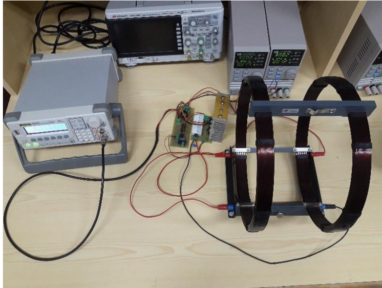
Rys. 4.25. Stanowisko ze źródłem prądowym do generowania zmiennego pola magnetycznego
