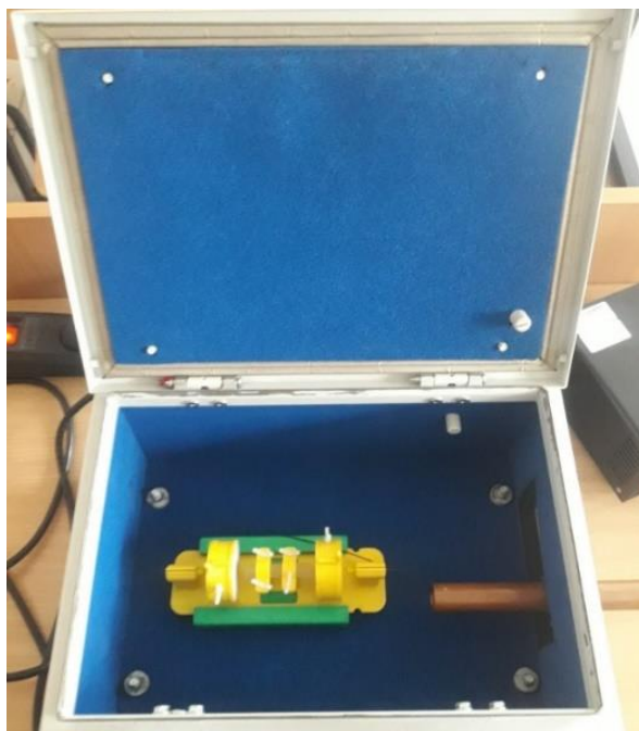
Rys. 5.23. Detektor w obudowie szczelnej elektromagnetycznie
