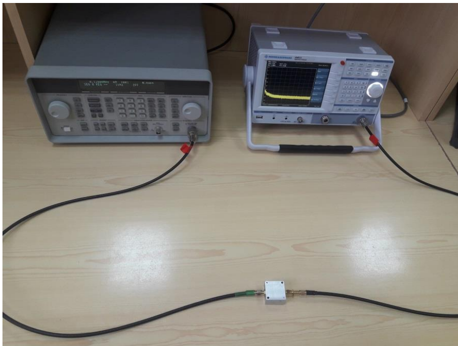
Rys. 5.30. Stanowisko do pomiaru charakterystyki częstotliwościowej układu filtrującego
