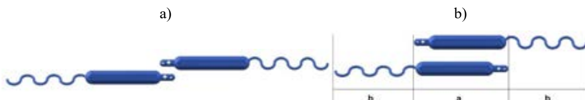
Rys. 5. Oddziaływanie pomiędzy dipolami w fazie SmA_2 (a), w fazie SmA_d (b).
