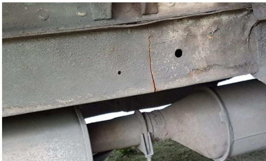
Rys. 7.4. Pęknięta rama nośna pojazdu Renault Master
