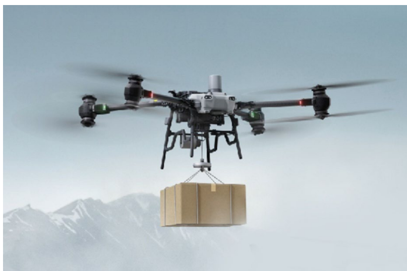
Rysunek 6.15. DJI FlyCart 30 - dron dostawczy o udźwigu 30 kg i zasięgu lotu 16 km
