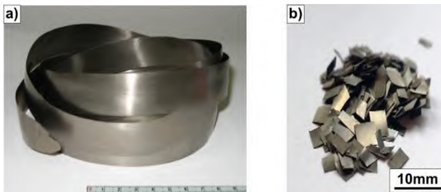
Rys. 1. Przykładowa postać materiału wyjściowego do badań własnych katalizatora – taśmy ze stopu Ni_3Al przed testami aktywności katalitycznej: a) widok ogólny (wymiary taśmy 80\mu m \times 20 mm \times 600 mm ), b) luźne fragmenty stanowiące złożo katalityczne (źródło: Monografia)
