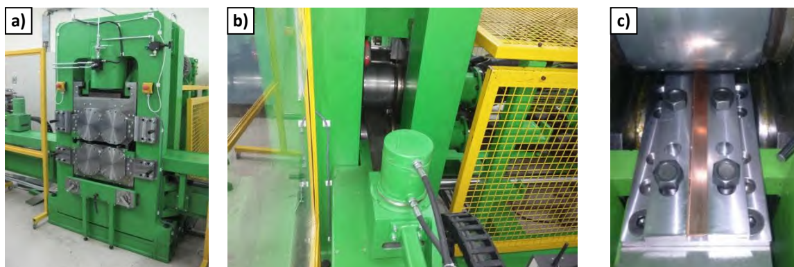
Rys. 22. Stanowisko do realizacji kontrolowanej obróbki plastycznej materiałów metalicznych o ograniczonej podatności do odkształcenia plastycznego: a) walcarka sexto (widok ogólny), b) w czasie walcowania z wykorzystaniem przeciwnaciągu, c) uchwyt do ograniczenia asymetrii blach/taśm/pasów walcowniczych
