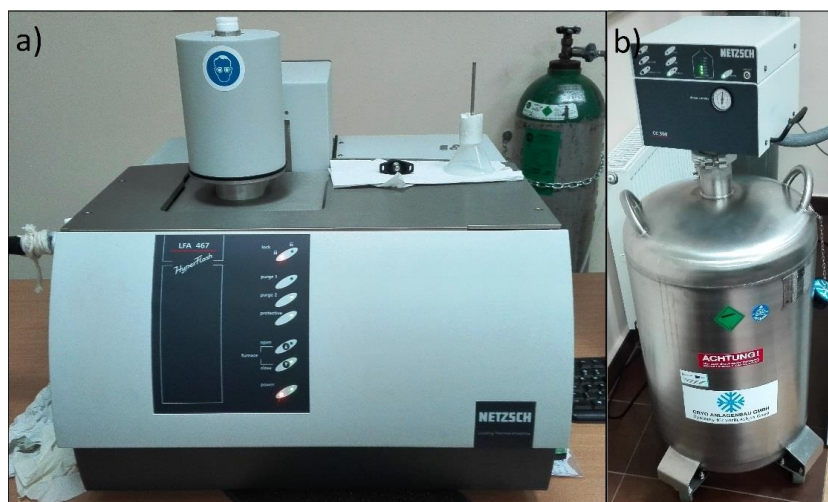
Rys. 2.2. Widok dyfuzometru LFA 467 HyperFlash (a) oraz zbiornika na ciekły azot z zintegrowanym kontrolerem CC300 (b).
