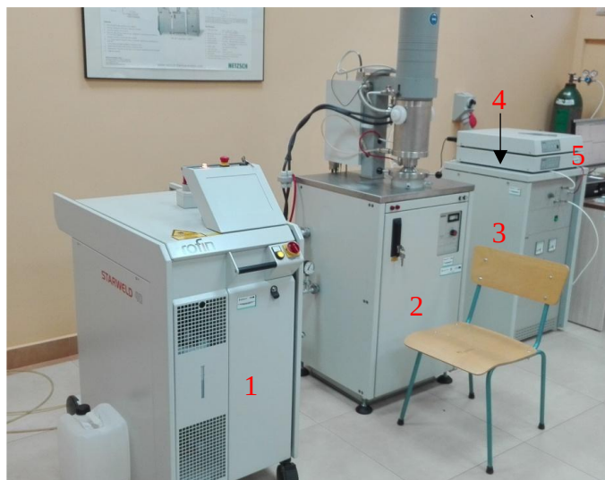
Rys. 2.3. Widok dyfuzometru LFA 427 z piecem wysokotemperaturowym. 1 – laser; 2 – dyfuzometr; 3 – blok zasilania dyfuzometru; 4 – układy sterujące pracą dyfuzometru i lasera; 5 – komputer.
