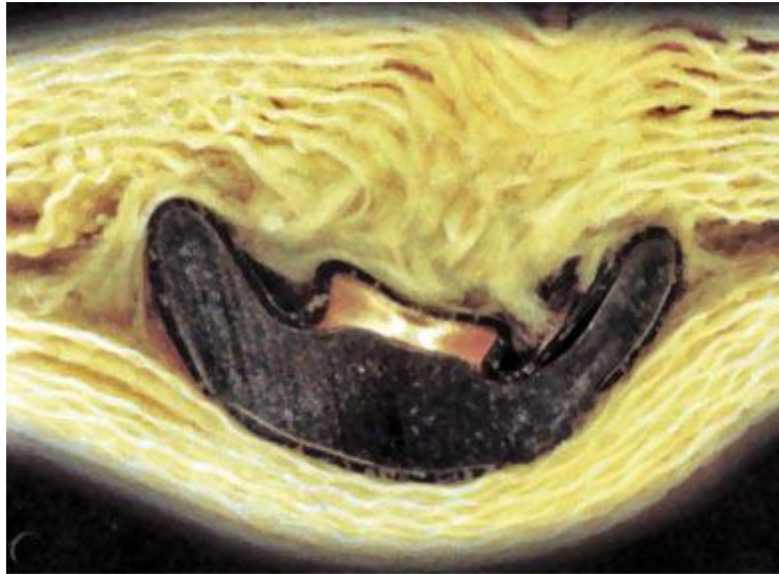
Rys. 1.7. Pocisk, który uległ tzw. grzybkowaniu podczas penetracji miękkiego wkładu aramidowego [22]
