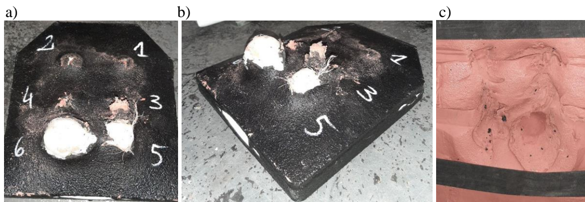
Rys. 5.12. Zdjęcie próbki P22/016 po ostrzale. a) widok z tyłu, b) widok z tyłu od narożnika, c) podłoże balistyczne
