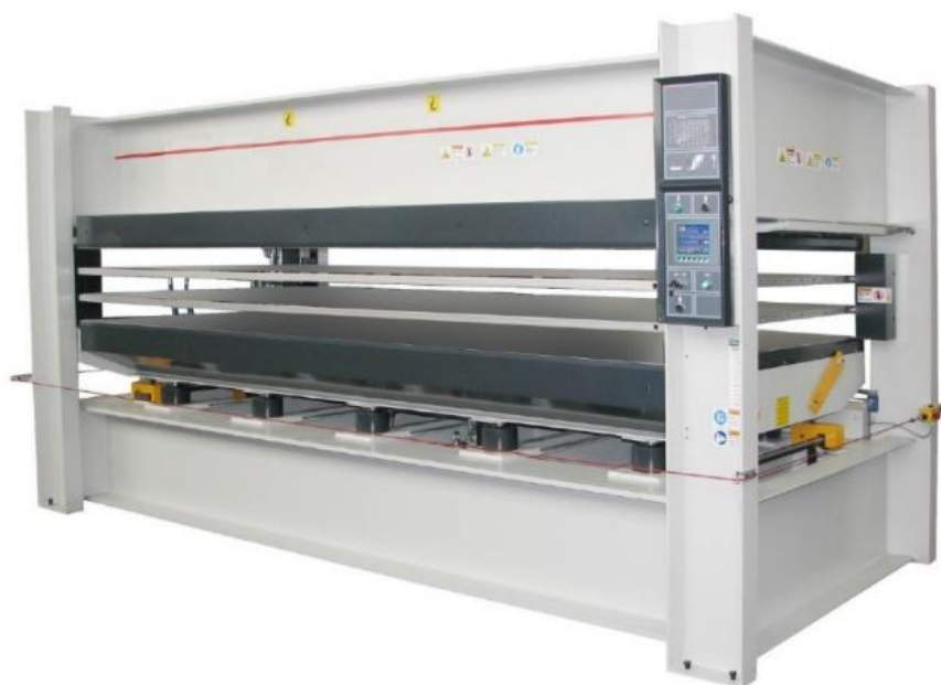
Rys. 4.5. Prasa wysokociśnieniowa użyta do wytwarzania wkładów balistycznych
