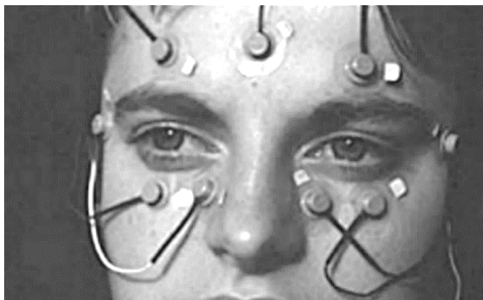
Rys. 2.4. System śledzenia wzroku metodą elektro-okulografii (Duchowski 2017)
