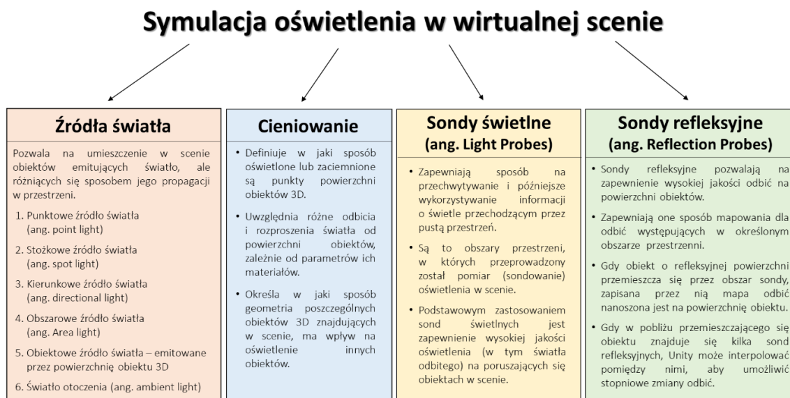
Rys. 6.8. Składniki systemu oświetlenia wirtualnej sceny w środowisku Unity
