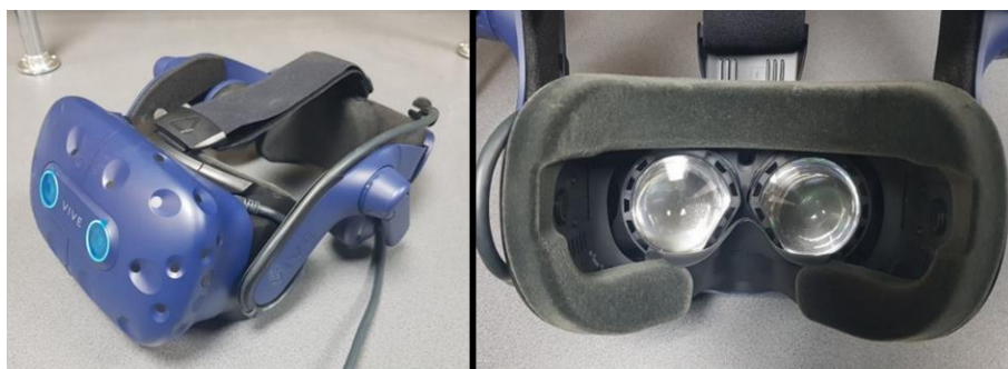
Rys. 2.18. System śledzenia wzroku firmy Tobii Technology zintegrowany z goglami Vive Pro Eye
