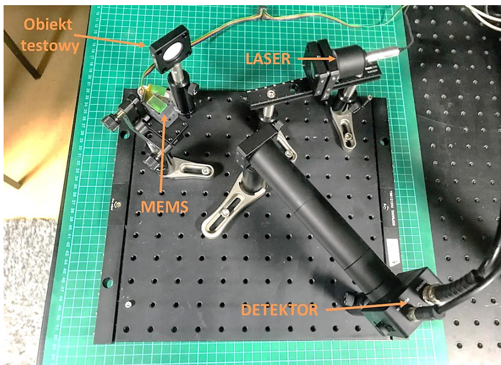
Rys. 7.6. Stanowisko pomiarowe do badań statycznych
