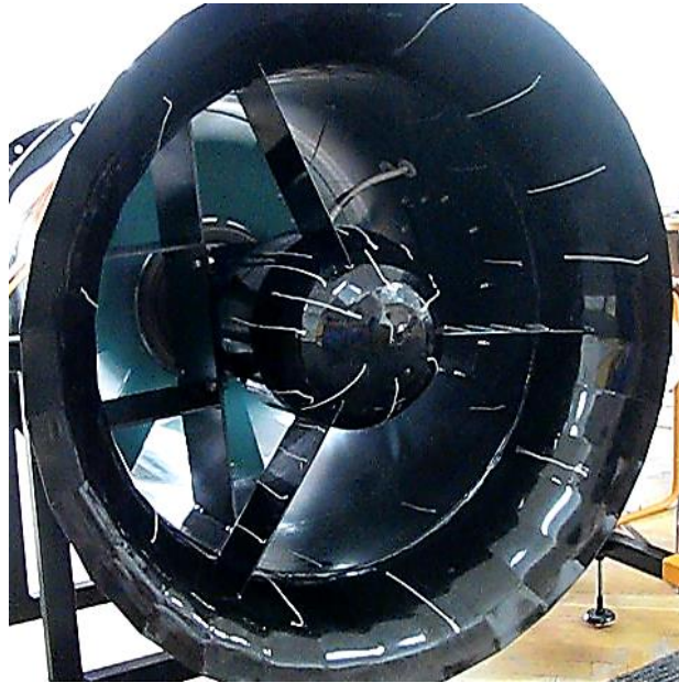
Rys. 1.10. Zastosowanie nitek do wizualizacji przepływu na wlocie do wentylatora osiowego.
