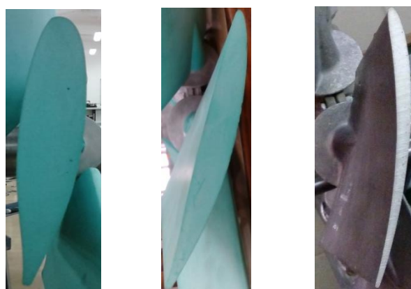
Rys. 4.18. Profile łopatek trzech wieńców wirnikowych wykorzystywanych w badaniach doświadczalnych oraz numerycznych.
