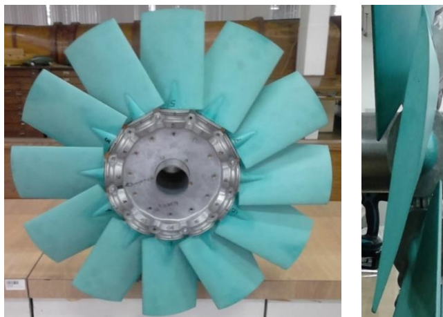
Rys. 4.8. 12-łopatwy wieńec wirnikowy wentylatora osiowego, profil łopat – NACA 65 810 .
