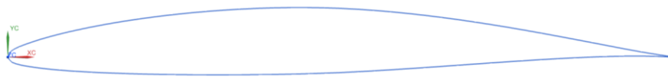
Rys. 4.1. Profil łopatki wirnikowej na przekroju średnim łopatki wieńca wirnikowego wentylatora osiowego o parametrach znamionowych Q=5\text{ m}^3/\text{s} oraz \Delta p_c=400\text{ Pa} - krzywa typu spline .
