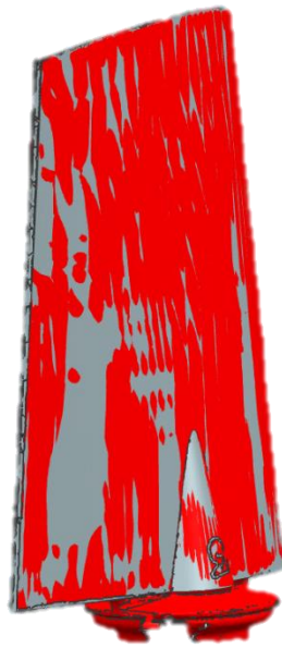
Rys. 4.15. Porównanie geometrii modelu wirtualnego (szary) z modelem uzyskanym w wyniku skanowania (czerwony).
