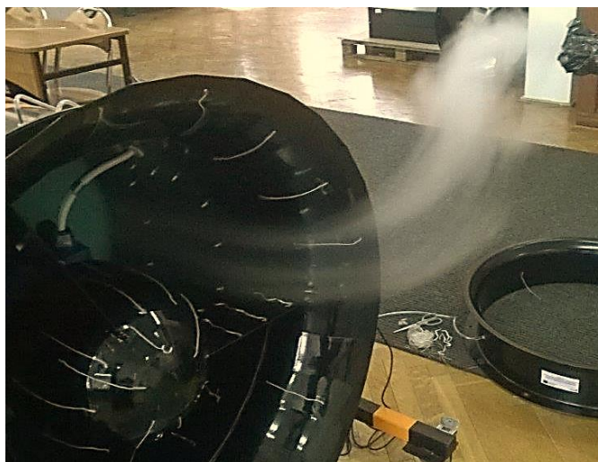
Rys. 1.11. Zastosowanie dymu do wizualizacji przepływu we wlocie do wentylatora osiowego.
