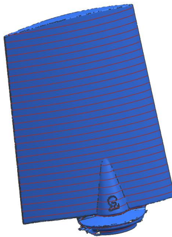
Rys. 4.11. Wybrane przekroje definiujące kształt łopatki.
