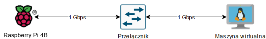
Rysunek 5.1: Schemat połączenia sieciowego pomiędzy urządzeniem IoT a serwerem CoAP
