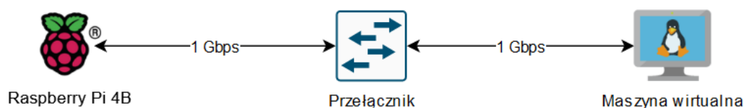
Rysunek 5.5: Schemat połączenia sieciowego pomiędzy urządzeniem IoT a serwerem badanego protokołu
