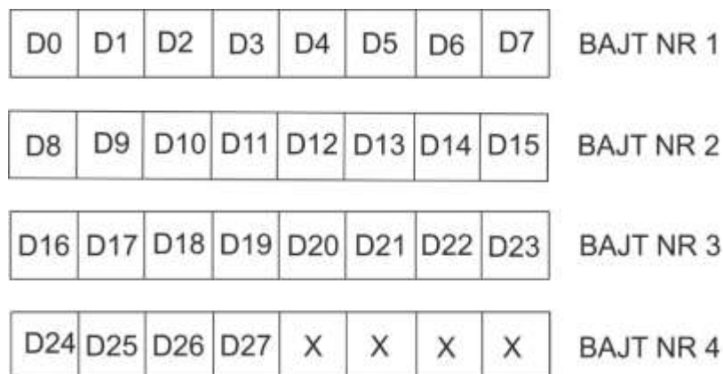
Rys. 7.8 Układ bitów w bajcie w ramce transmisyjnej.
