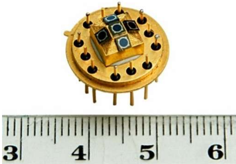
Rys. 5.6 Sensor kąta padania promieniowania (skala w cm)
