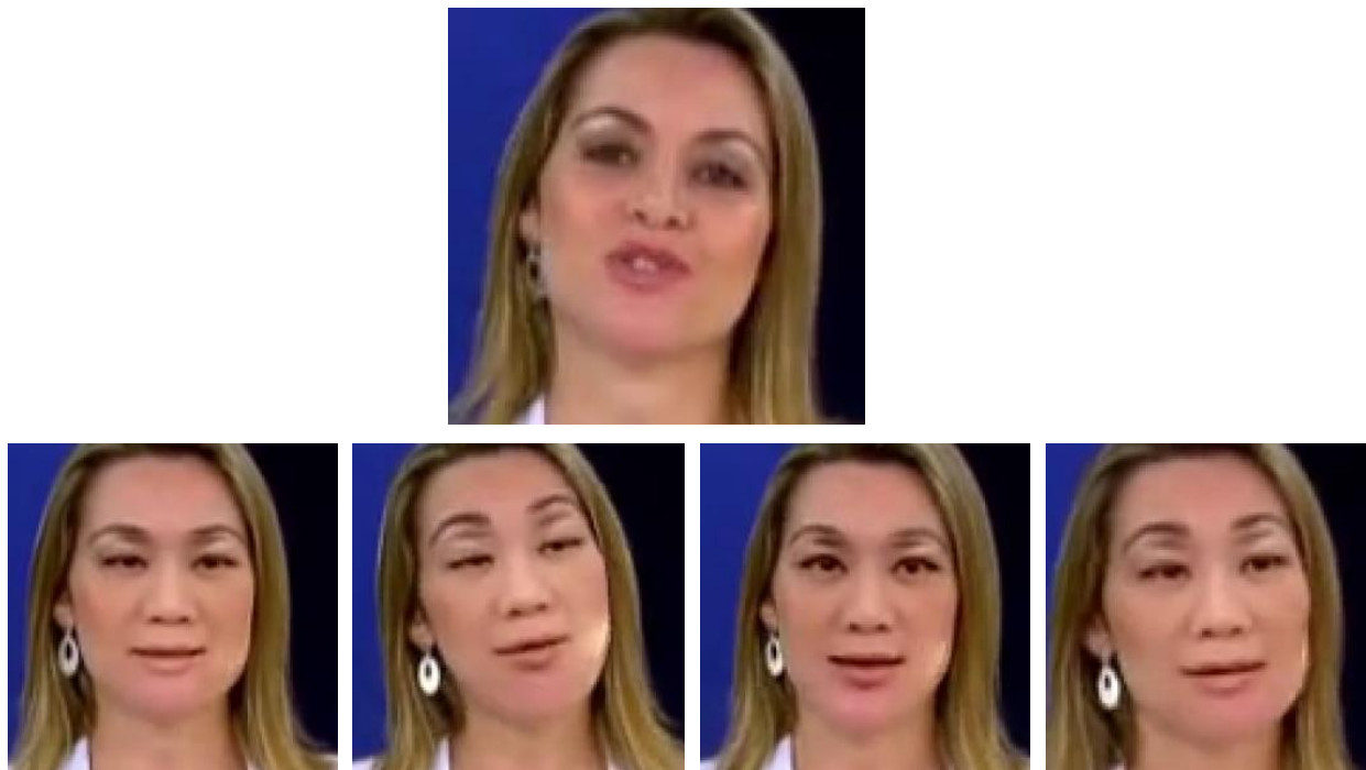
Rys. 5.5 Przykłady obrazów deep fake (wiersz dolny) z bazy Faceforensics++ utworzonych z obrazu oryginalnego (wiersz górny) metodą DeepFake (algorytm FakeApp ).
