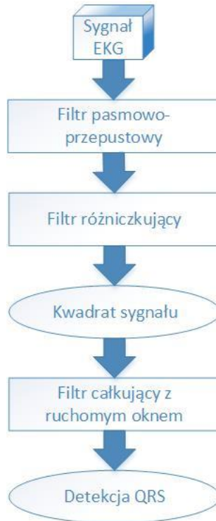
Rys. 3.4 Schemat detekcji zespołu QRS w sygnałach EKG według algorytmu Pana-Tompkinsa.
