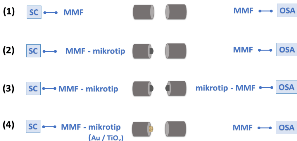
Rysunek 43. Konfiguracje układu do badania właściwości transmisyjnych mikrotipów: (1) dwa światłowody MMF, (2) mikrotip wytworzony na włóknie nadawczym, (3) mikrotip wytworzony na włóknie nadawczym i odbiorczym, (4) mikrotip domieszkowany NPs złota i tlenku tytanu wytworzony na włóknie nadawczym; SC – źródło światła; OSA – analizator widma
