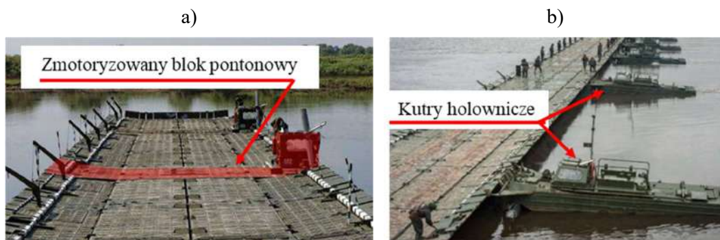
Rys. 1.5. Jednostki napędowe parku PP-91: a) blok zmotoryzowany MZ-235 wpięty w oś mostu (kolor czerwony), b) kuter holowniczy BMK-255 [6]
