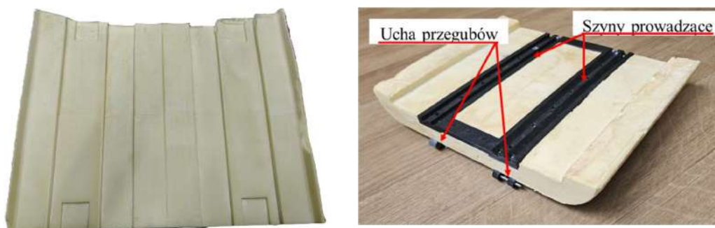
Rys. 6.13. Model mostu pontonowego: a) odlew korpusu modelu, b) model mostu z oznaczonymi przegubami łączącymi kolejne bloki pontonowe
