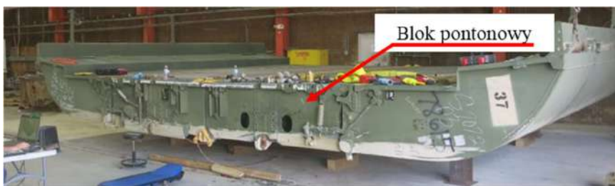
Rys. 6.12. Pojedynczy blok pontonowy modelowanego obiektu rzeczywistego [27]
