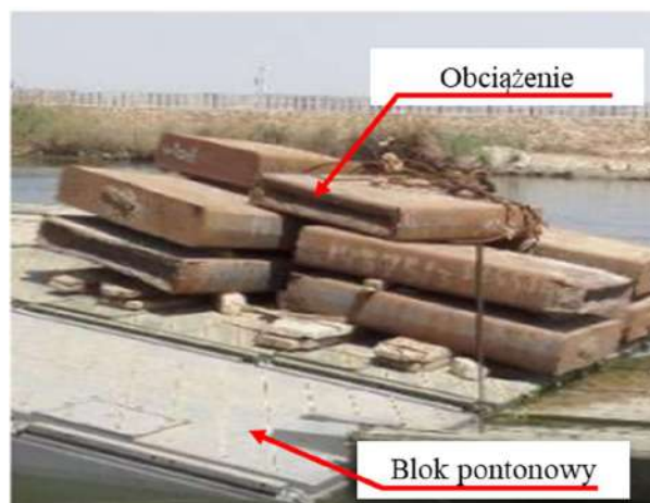
Rys. 2.15. Obiekt rzeczywisty rozpatrywany w pracy [43] obciążony ładunkiem
