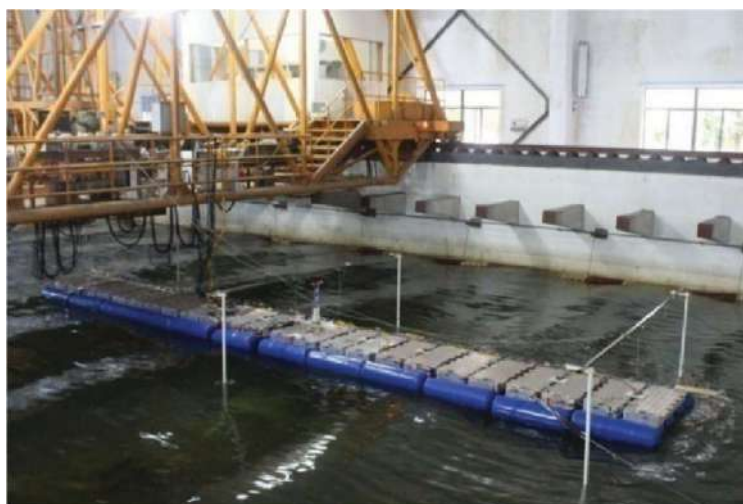
Rys. 2.9. Model doświadczalny mostu do badań reakcji konstrukcji na fale środowiskowe [32]
