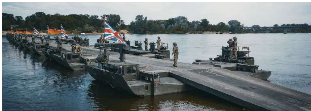
Rys. 1.14. Przeprawa mostowa zrealizowana z wykorzystaniem M3 [20]
