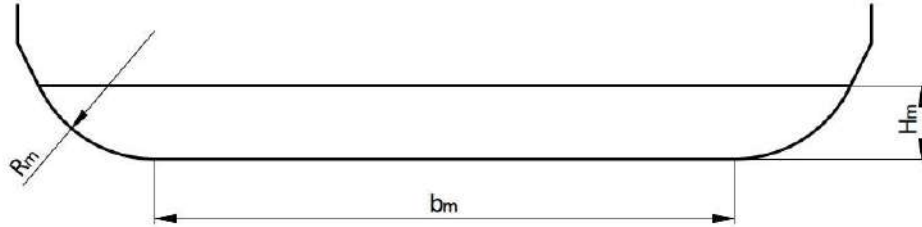
Rys. 6.5. Zarys przekroju wzdłużnego bloku pontonowego z wymiarami wykorzystanymi do wyznaczenia siły wyporu
