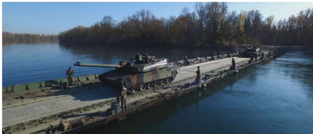
Rys. 1.10. Przeprawa mostowa zrealizowana z wykorzystaniem PFM [16]
