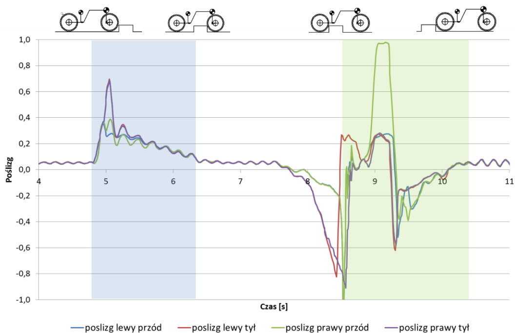
Rys. 9.24. Przebieg poślizgu poszczególnych kół podczas badań symulacyjnych platformy badawczej podczas pokonywania przeszkody typu murek przy aktywacji układu przy s_1=0,10 oraz s_2=0,30 oraz maksymalnym momencie hamującym o wartości 25% momentu wejściowego
