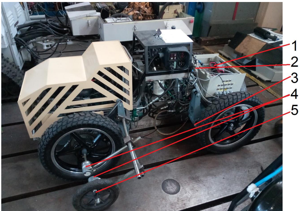
Rys. 7.12. Widok platformy badawczej, 1 – urządzenie rejestrujące, 2 – czujniki ciśnienia, 3 – czujniki prędkości obrotowej silników hydraulicznych, 4 – enkodery obrotowe, 5 – wolne koło
