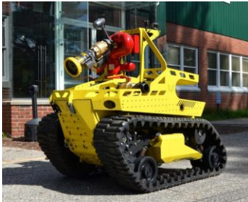
Rys.1.1. Bezzałogowe Platformy Lądowe wysokiej mobilności: a) robot gaśniczy Therrmite firmy Howe and Howe [104], b) robot do rozminowywania Protector [109]
