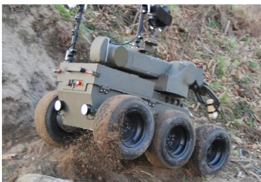
Rys. 1.2. Platformy wysokiej mobilności; a) robot IBIS firmy PIAP [103], b) kołowy robot MoonBuggy [108]
