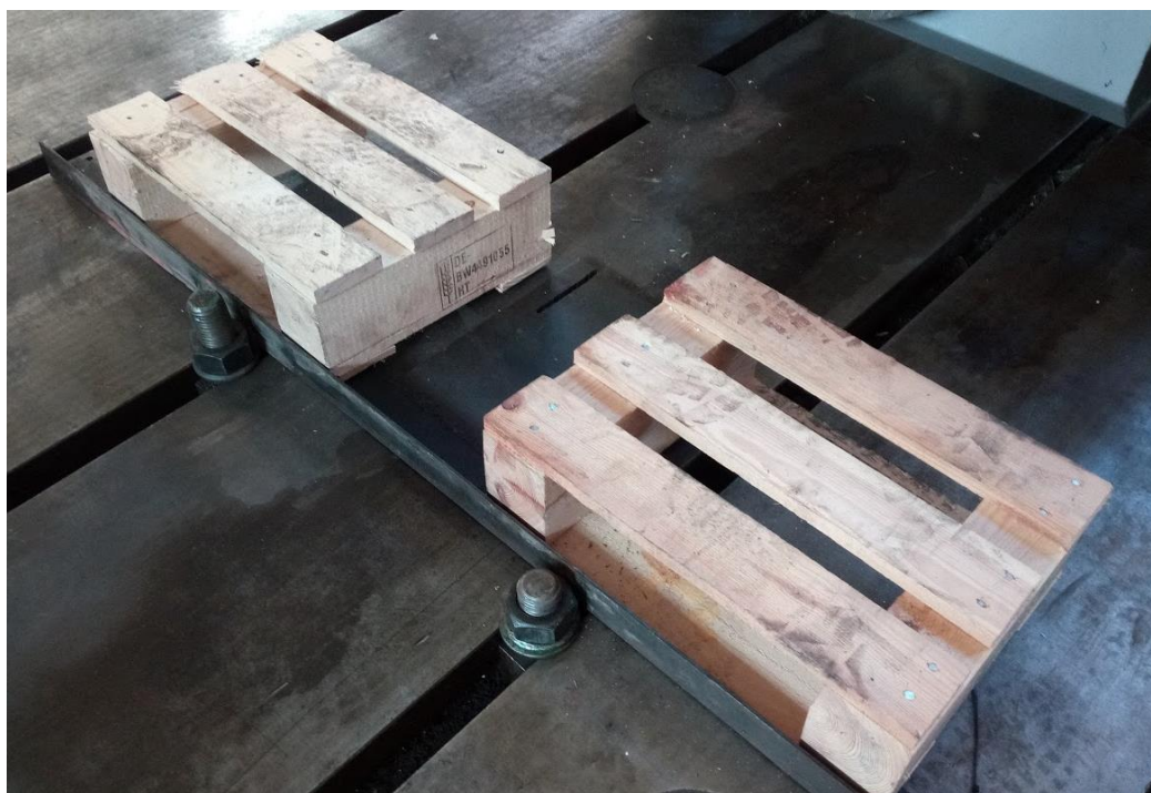
Rys. 7.9. Widok przeszkody typu murek zbudowanej na potrzeby badań
