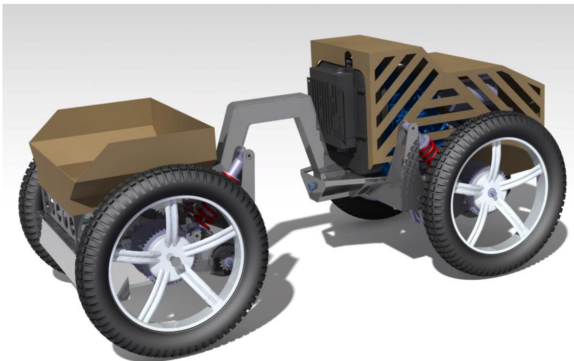
Rys. 7.7. Projekt modelu Lekkiej Kołowej Bezzałogowej Platformy Lądowej z napędem hydrostatycznym – widok ogólny
