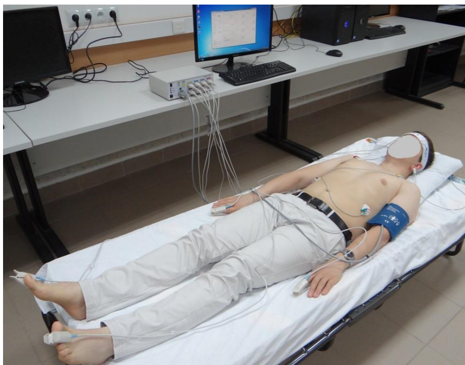
Rys. 3.1. Widok stanowiska pomiarowego z rozmieszczonymi sensorami pomiarowymi
