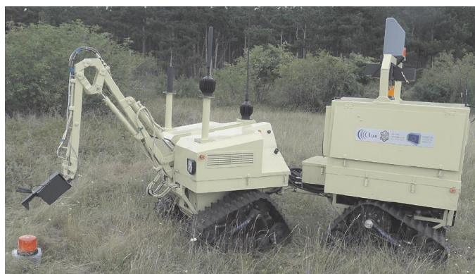
Rys. 1.3. Bezzałogowe pojazdy lądowe: a - HDT's Protector robot o skręcie burtowym [109], b - Tarvos o zwrotnicowym układzie skrętu [113], c - Dromader o przegubowym układzie skrętu [72]
