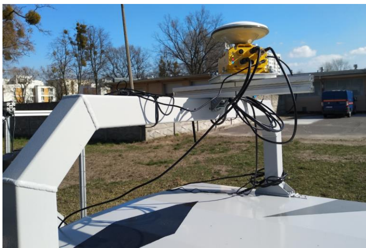
Rys. 6.2. Widok zamontowanego odbiornika satelitarnego
