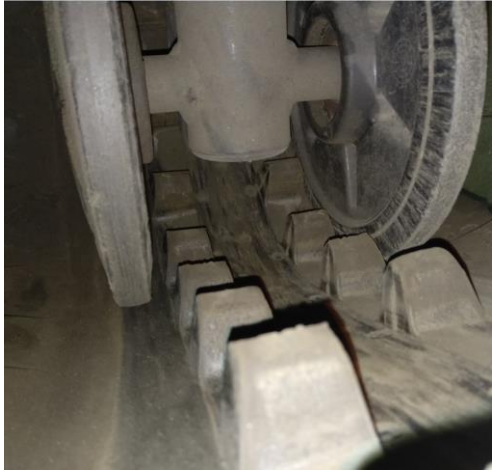
Rys. 6.6. Luz poprzeczny pasa gaśnicy pomiędzy kołami jezdny platformy: a - widok, b - wymiary
