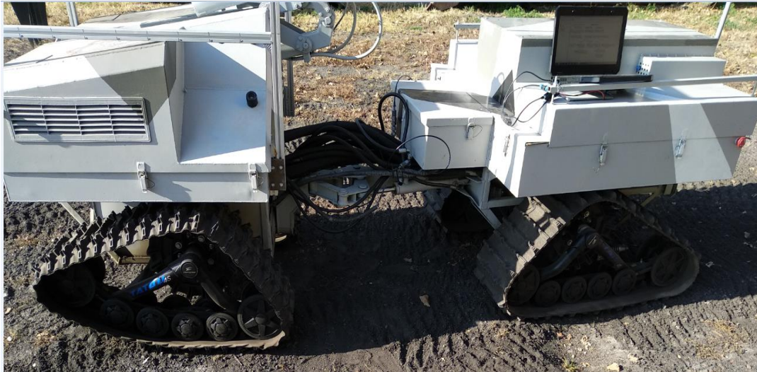
Rys. 5.10. Badania układu skrętu na podłożu gruntowym
