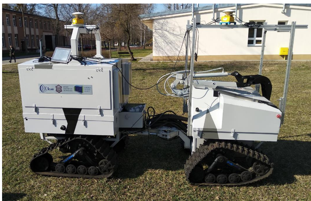
Rys. 6.1. Widok platformy Dromader z zamontowanymi odbiornikami satelitarnymi
