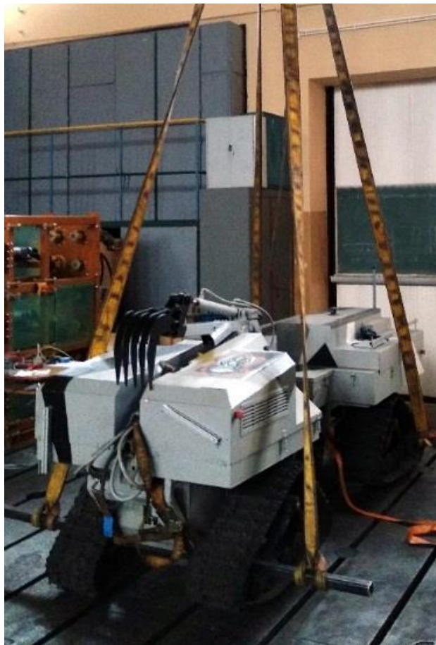
Rys. 5.9. Badania układu skrętu bez kontaktu układu jezdnego z podłożem
