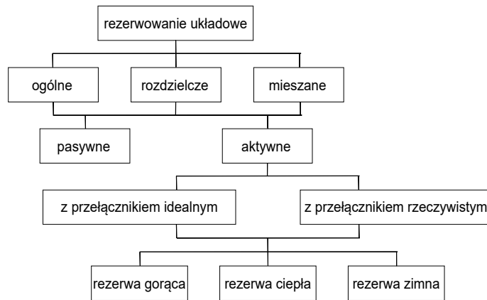
Rysunek 3.2: Klasyfikacja rezerwowania układowego. (źródło: opracowanie własne na podstawie [110])
