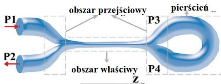
Rysunek 25 Schemat sprzęgacza w konfiguracji interferometru pętlowego [136].
