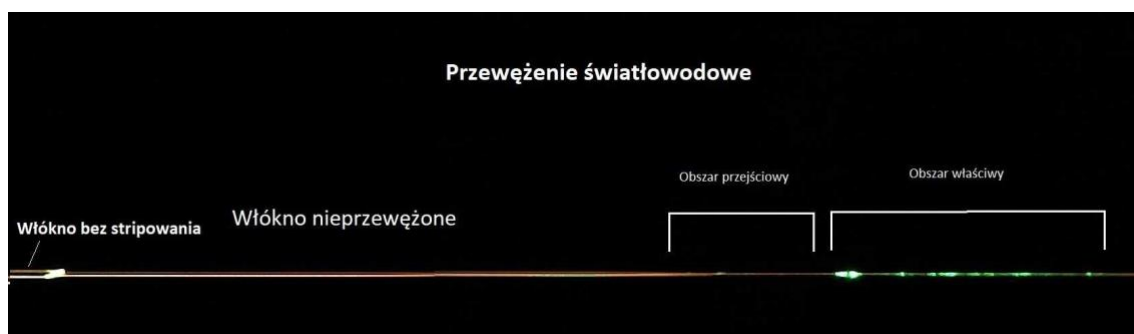
Rysunek 39 TOF wykonana na stanowisku FOTET z podziałem na poszczególne obszary TOF (na zdjęciu pokazano połowę TOF) [213].
