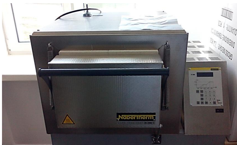
Rys. 5.15. Stanowisko do obróbki cieplnej wyposażone w piec Nabertherm P300
