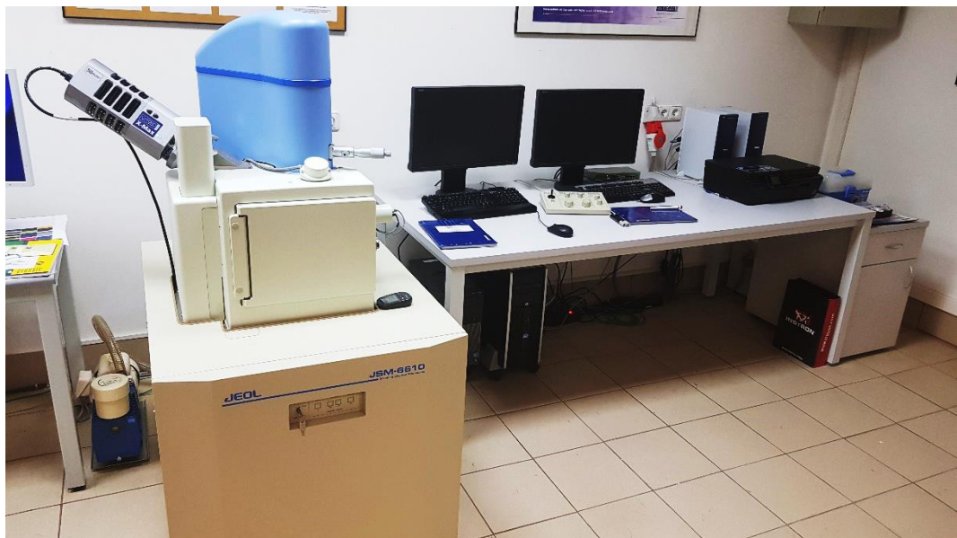
Rys. 5.8. Mikroskop Jeol JSM-6610 z modułem EDS
