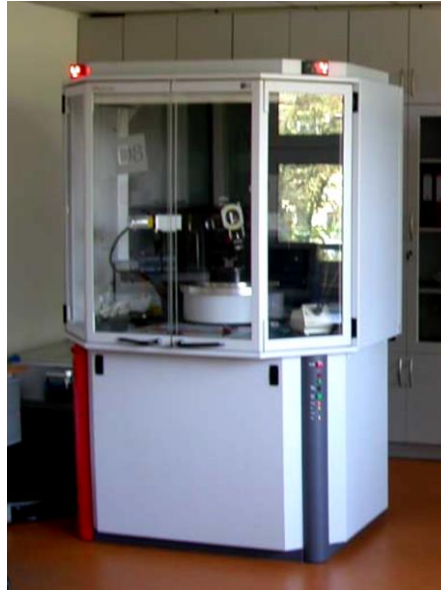
Rys. 5.12. Dyfraktometr rentgenowski „Bruker D8 Discover w Laboratorium dyfrakcji rentgenowskiej Instytutu Metalurgii i Inżynierii Materiałowej Polskiej Akademii Nauk w Krakowie
