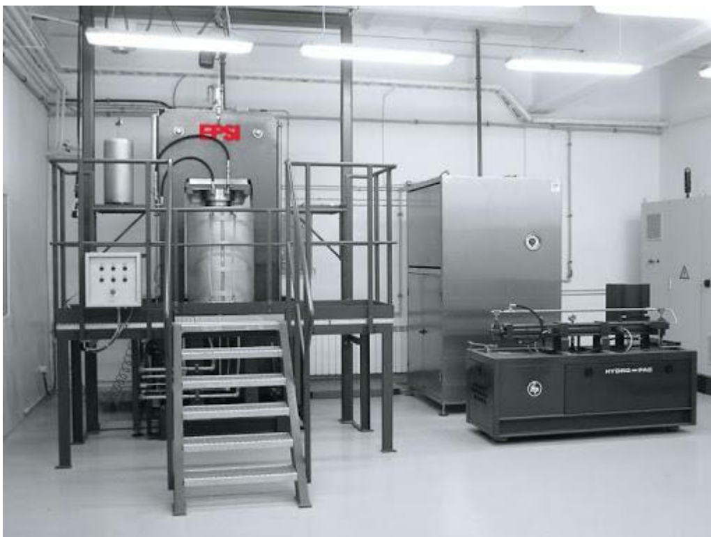
Rys. 5.14. Wysokotemperaturowa prasa izostatyczna z piecem Nabertherm VHT 822 - GR w Zakładzie Nanotechnologii Instytutu Ceramiki i Materiałów Budowlanych w Warszawie
