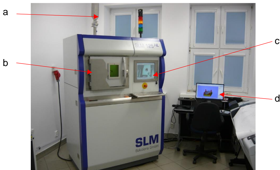
Rys. 5.3. Stanowisko do wytwarzania techniką SLM; a - zbiornik na proszek metaliczny, b - komora robocza, c - panel sterujący, d - stanowisko do przygotowywania procesu wytwarzania z oprogramowaniem Magics 19
