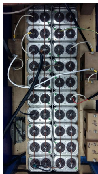
Rys. 2.14. Elementy układu generacji plazmy: układ ładowania oraz rozładowania (po lewej) oraz bateria kondensatorów wraz z cewkami (po prawej)
