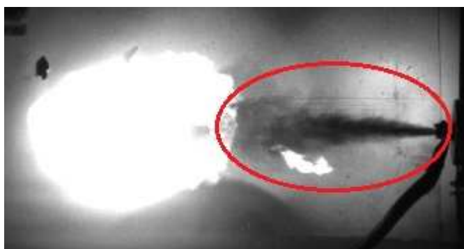
Rys. 2.7. Generacja plazmy z wykorzystaniem drutu wolframowego
