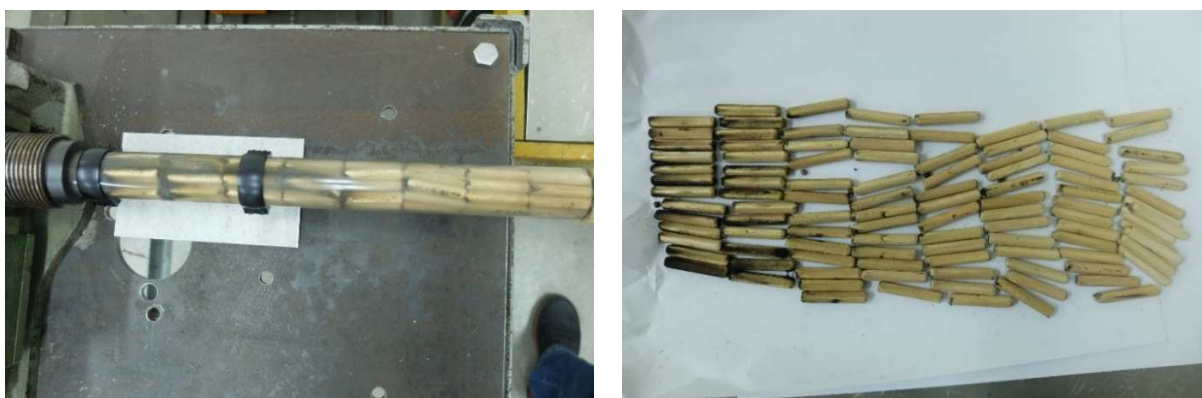
Rys. 3.6. Próbkę po teście z wykorzystaniem zapłonu czarnoprochowego
