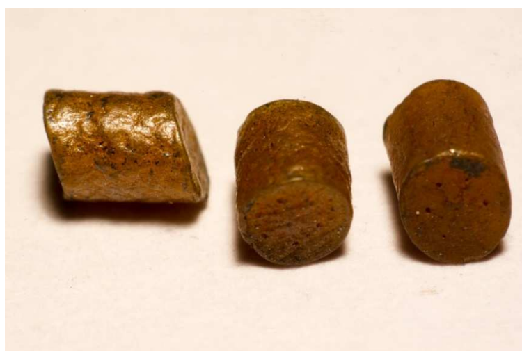
Rys. 3.8. Ziarna prochu 5/7 cfl pokryte warstwą miedzi
