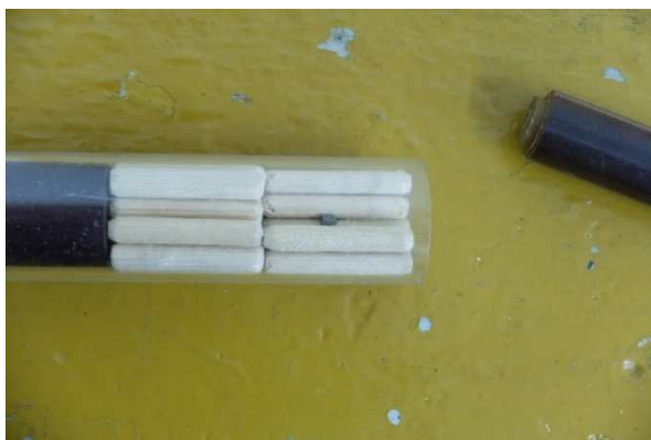
Rys. 3.5. Przygotowanie próbki z ziarnem prochowym pomiędzy drewnianymi kołkami
