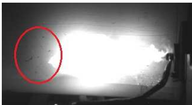
Rys. 2.9. Generacja plazmy z wykorzystaniem drutu niklowego
