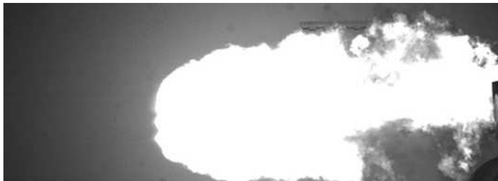
Rys. 2.6. Generacja plazmy z wykorzystaniem drutu miedzianego
