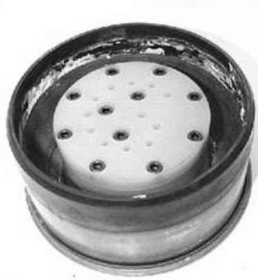
Rys. 1.23. Zapłonnik plazmowy wykorzystywany w amunicji czołgowej kalibru 120 mm M829A2 [38]
