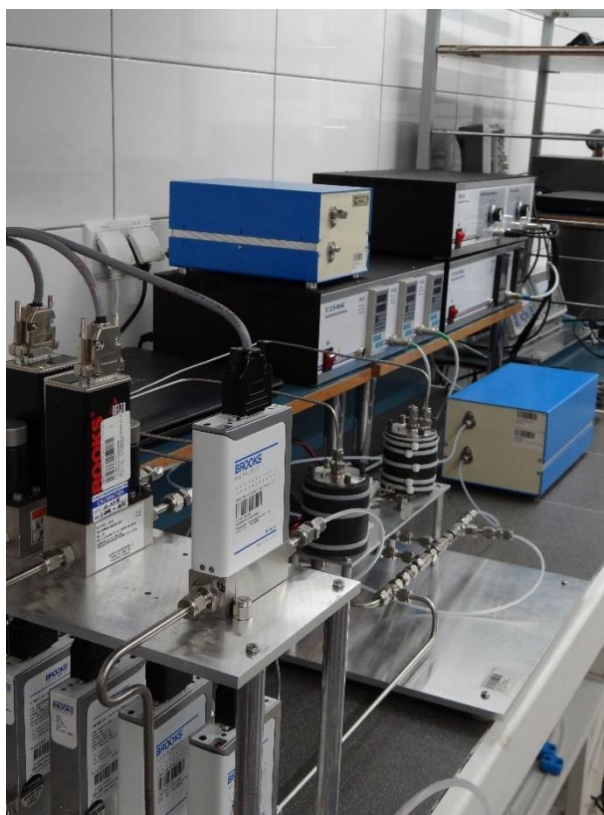
Rys. 14. Układ do wytwarzania mieszanin gazowych.
