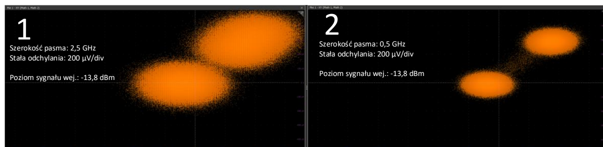
Rys. 6.2. Zdjęcia zobrazowania oscyloskopu z pomiaru częstotliwości sygnału MDCz dla różnych szerokości pasma wejściowego
