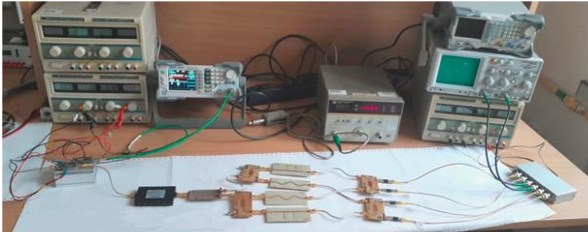
Rys. 6.4. Schemat blokowy wraz ze zdjęciem układu MDCz z oscyloskopem analogowym wykorzystanym do pomiaru częstotliwości
