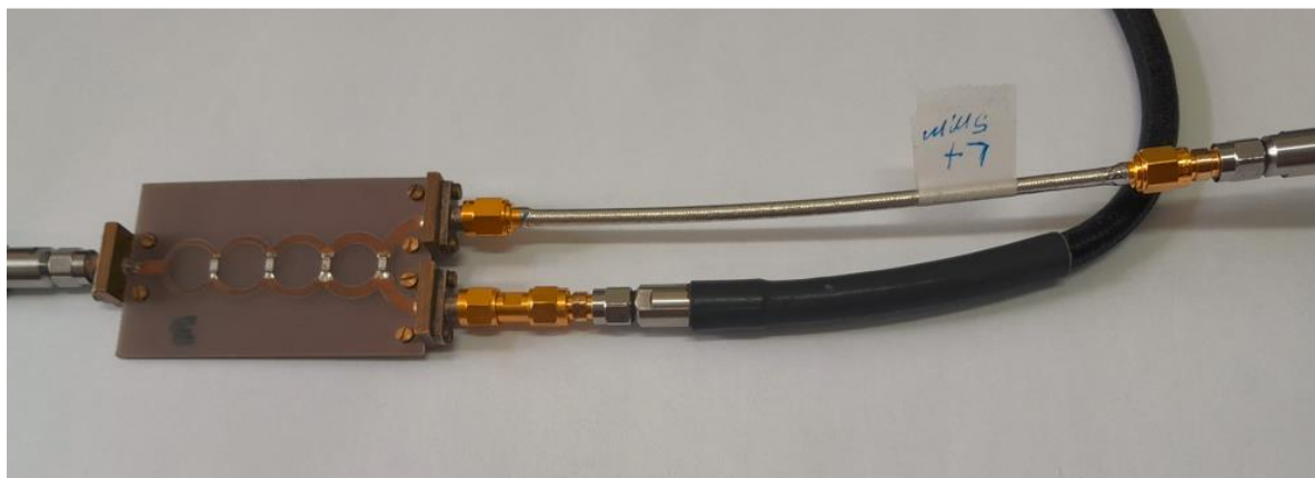
Rys. 5.12. Widok wykonanych elementów UWPRF
