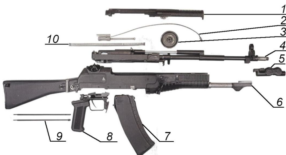
Fot. 10. 5,45 mm karabinek AN-94 Abakan częściowo rozłożony: 1 – pokrywa komory zamkowej, 2 – dosyłacz, 3 – koło przekładni dosyłacza, 4 – komora zamkowa z lufą i suwadłem, 5 – urządzenie wylotowe, 6 – korpus broni z kolbą, 7 – magazynek, 8 – komora spustowa, 9 – wycior, 10 – sprężyna powrotna (fot. [66])
