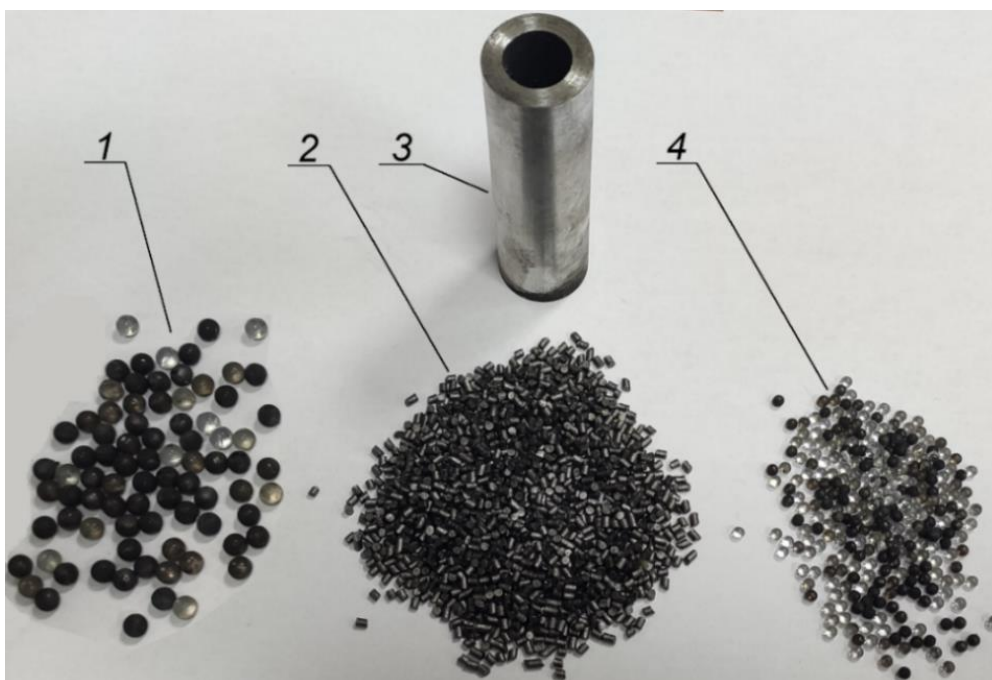
Fot. 16. Wypełnienia komory manometrycznej w porównaniu z ziarnami prochu NC1214: 1 – kulki szklane o średnicy 4 mm, 2 – ziarna prochu NC1214, 3 – tuleja, 4 – kulki szklane o średnicy 2 mm (fot. [75])
