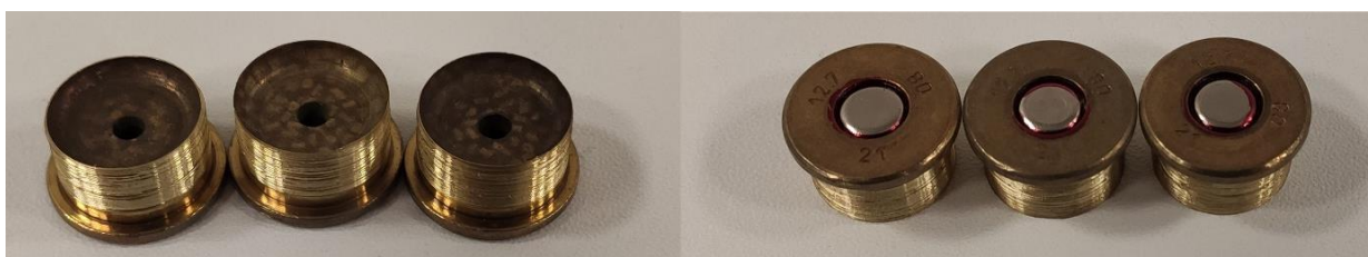
Fot. 15. Zmodyfikowane łuski amunicji 12,7x99 mm (fot. opracowanie własne)
