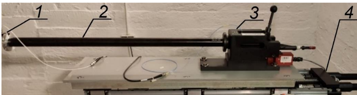
Fot. 18. Stanowisko do badań balistycznych amunicji: 1 – przetwornik ciśnienia umieszczony na wylocie lufy, 2 – lufa balistyczna, 3 – nasada zamkowa, 4 – uniwersalna podstawa STZA12M1 (fot. opracowanie własne)
