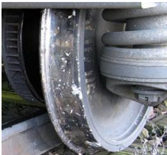
Fot. 1.1. Uszkodzenie obręczy kół spowodowane tłuczniem (fotografia własna)
