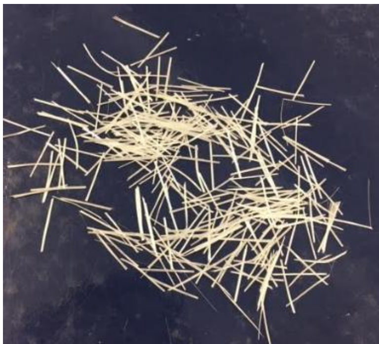
Fot. 3.3. Włókna szklane wykorzystane jako dodatek do betonu Z4 (fot. własna)
