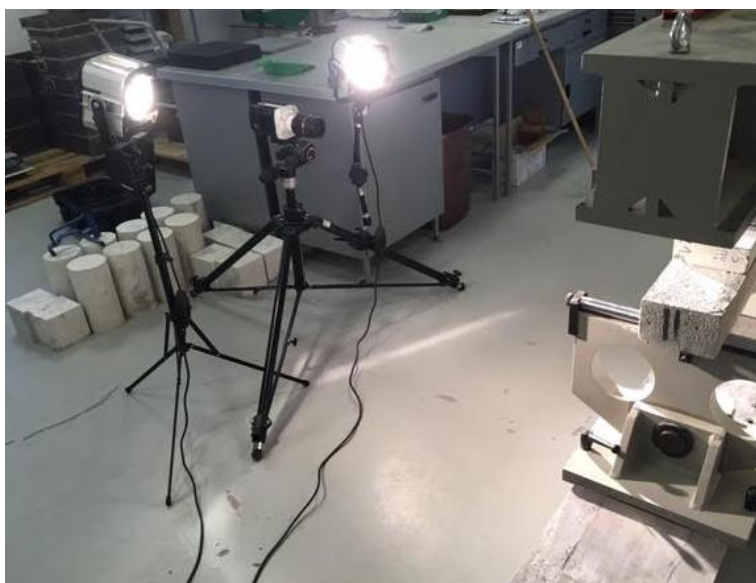
Rys. 5.8. Kamera PHANTOM MIRO LC310 wraz z wyposażeniem na stanowisku pomiarowym (fot. własna)
