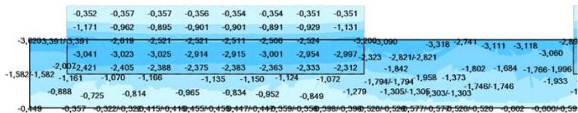
Rys. 6.8 Naprężenia w kierunku poprzecznym (beton Z3) (por. z Rys. 6.4.)
