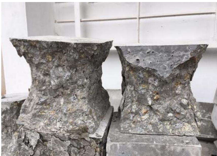
Fot. 4.2. Próbkki betonu po przeprowadzeniu badania (fot. własna)
