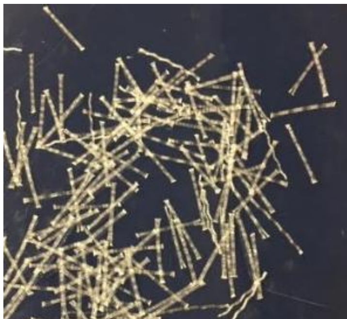
Fot. 3.2. Włókna polimerowe wykorzystane jako dodatek do betonu Z3 (fot. własna).
