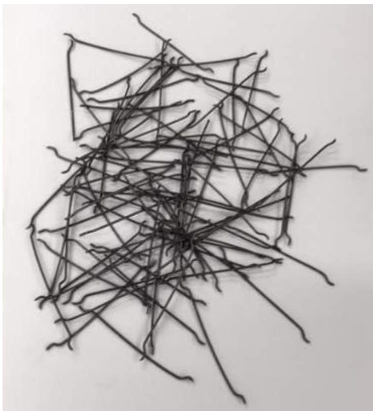
Fot. 3.1. Włókna stalowe wykorzystane jako dodatek do betonu Z2 (fot. własna).
