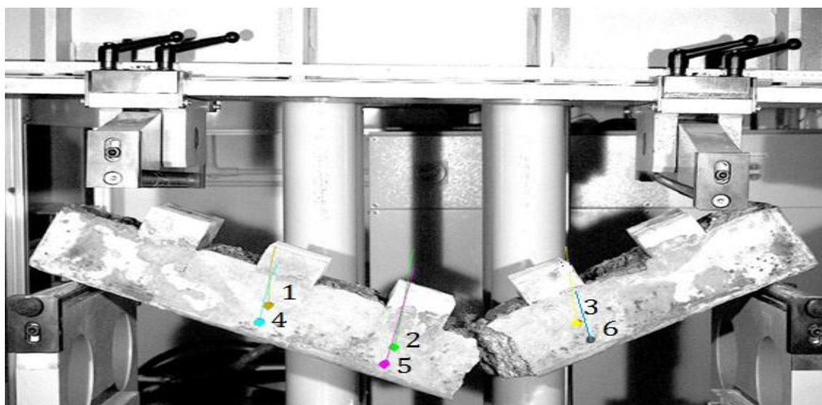
Fot. 5.11. Moment zniszczenia próbki wraz z widocznymi punktami pomiarowymi (fot. własna)
