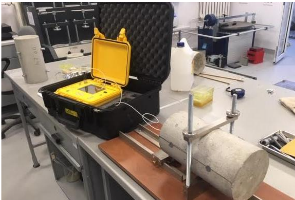
Fot. 4.4. Nieniszczące badanie modułu sprężystości betonu (fot. własna)
