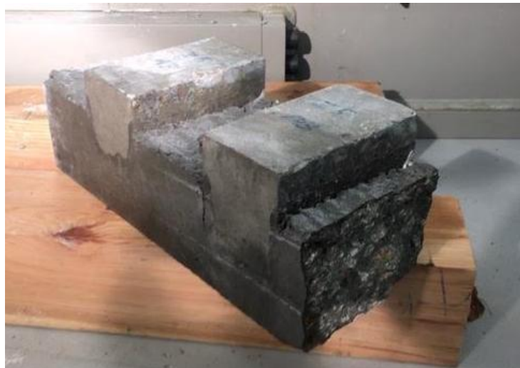
Fot. 5.12. Próbką po badaniu wytrzymałości na rozciąganie przy zginaniu (fot. własna)
