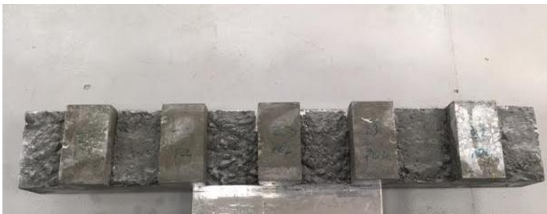
Fot. 5.9. Przygotowana próbka do badania wytrzymałości na zginanie (fot. własna)
