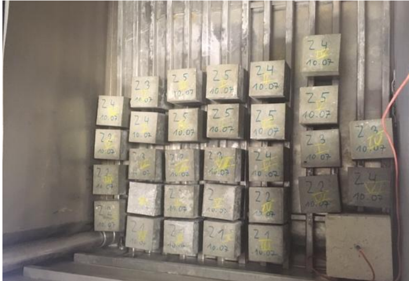
Fot. 4.3. Próbków betonów Z1-Z5 ułożone w komorze zamrażarki (fot. własna)
