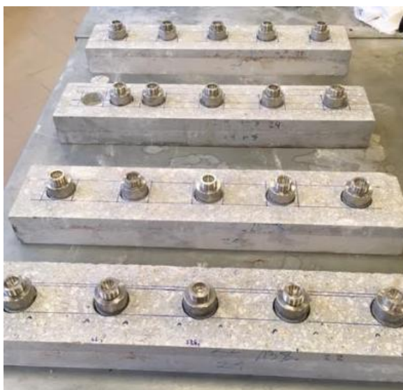
Fot. 5.2. Próbki betonowe przygotowane do badania pull-off (fot. własna)
