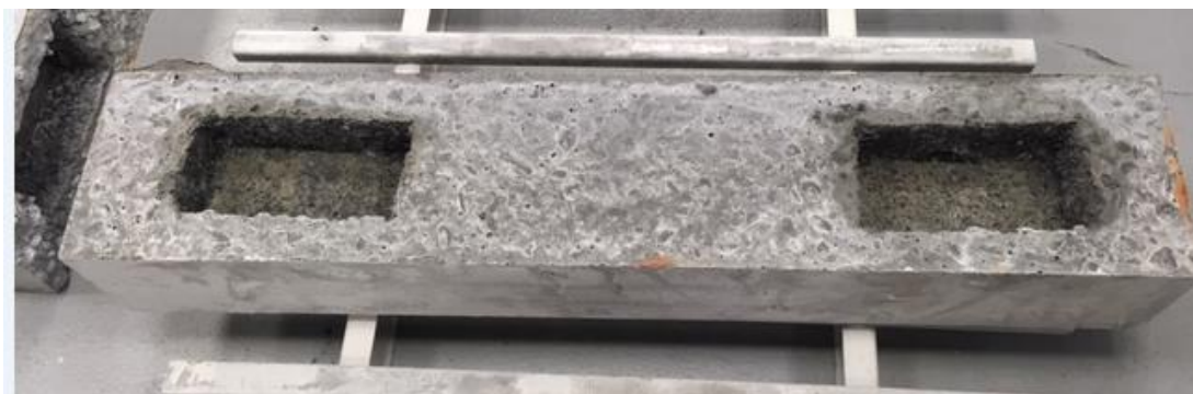
Fot. 5.5. Próbkę referencyjną do sprawdzenia zespolenia betonów (fot. własna)
