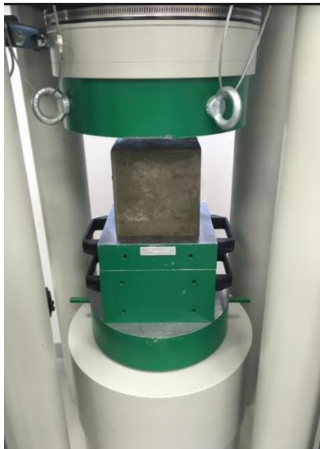
Fot. 4.1. Prasa do badań wytrzymałościowych (fot. własna)
