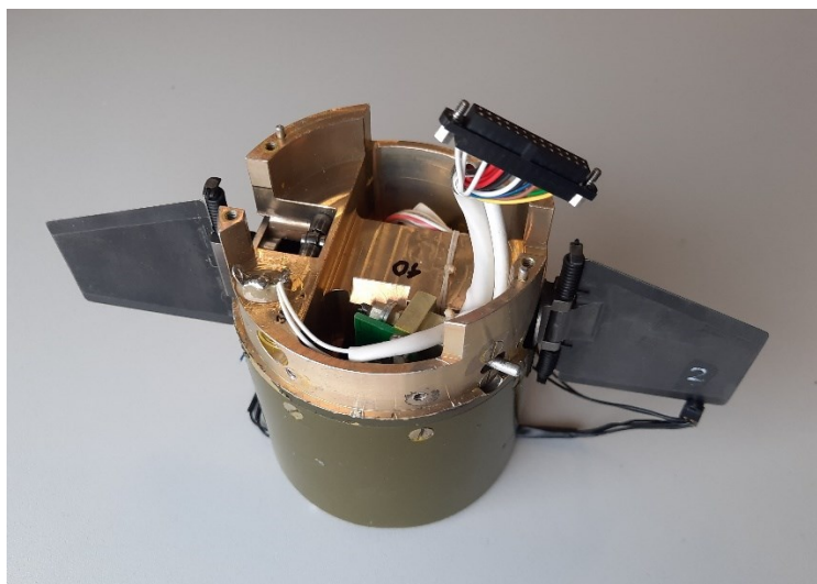
Rys. 3.12. Przedział sterowania lotem ppk. Źródło: opracowanie własne za zgodą TSM
