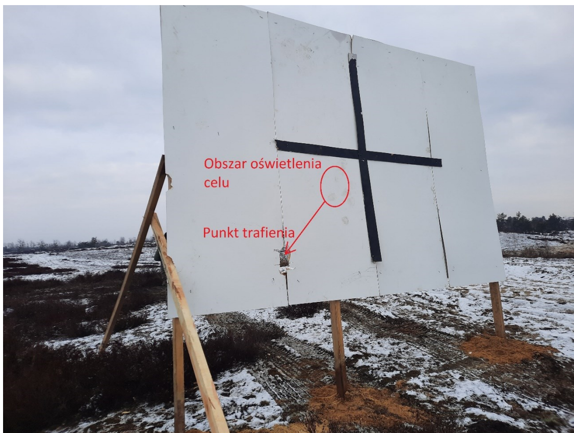
Rys. 10.15. Tarcza po trafieniu przez ppk. Zaznaczono punkt trafienia oraz obszar podświetlenia celu przez stanowisko startowo-celownicze. Źródło: opracowanie własne za zgodą MESKO S.A.
