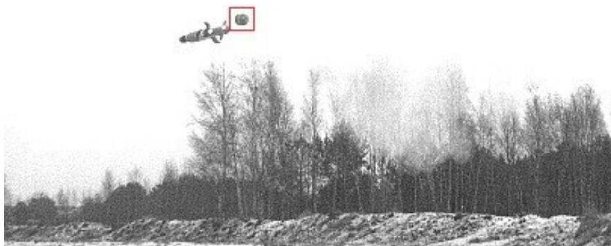
Rys. 10.5. Oddzielenie silnika startowego od reszty konstrukcji ppk. Silnik startowy oznaczono czerwoną ramką. Źródło: opracowanie własne za zgodą MESKO S.A.
