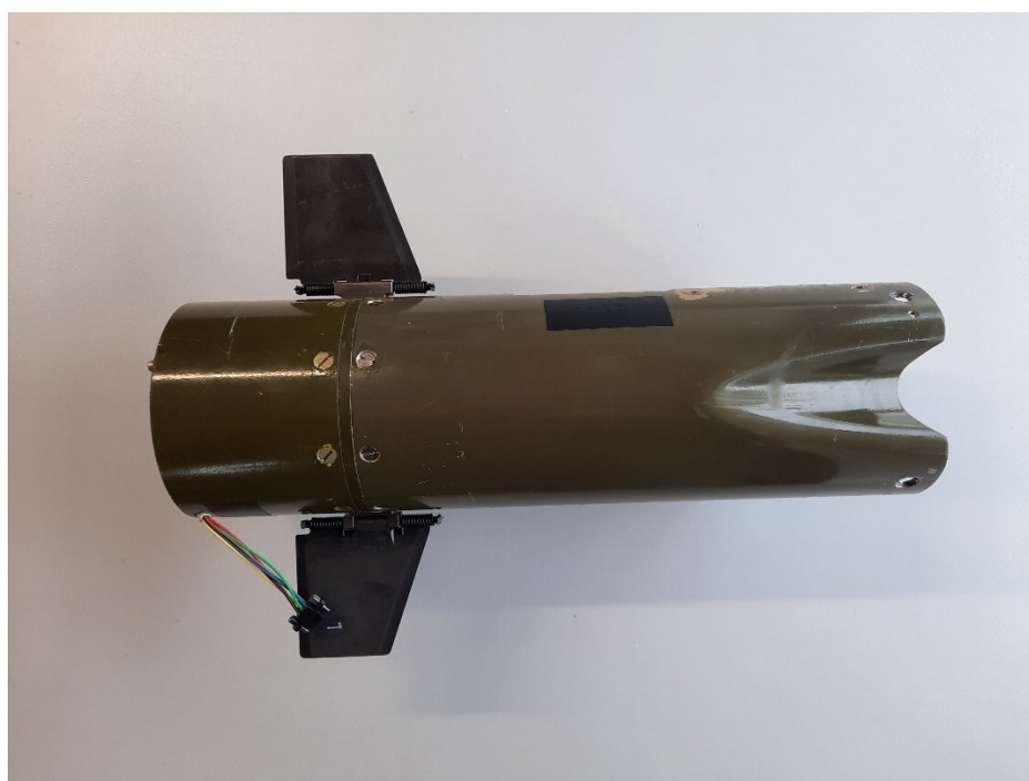
Rys. 3.11. Przedział kierowania lotem połączony z przedziałem sterowania lotem ppk. Źródło: opracowanie własne za zgodą TSM
