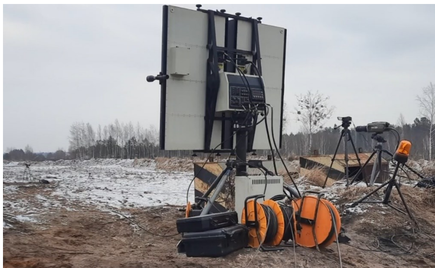
Rys. 10.1. Radar Dopplera śledzący ppk w locie na poligonie. Źródło: opracowanie własne za zgodą Wojskowego Instytutu Technicznego Uzbrojenia i MESKO S.A.
