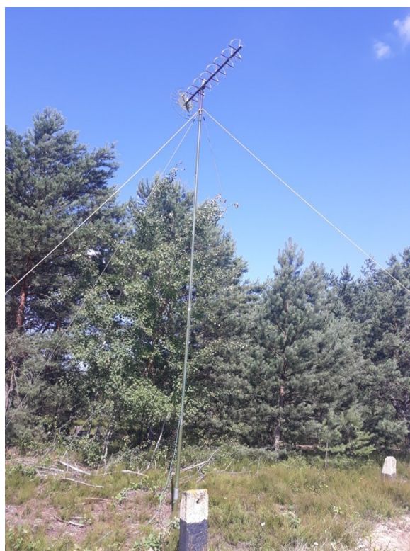
Rys. 10.2. Antena naziemnej stacji odbiorczej sygnału wysyłanego przez moduł telemetry ppk. Źródło: opracowanie własne za zgodą MESKO S.A.
