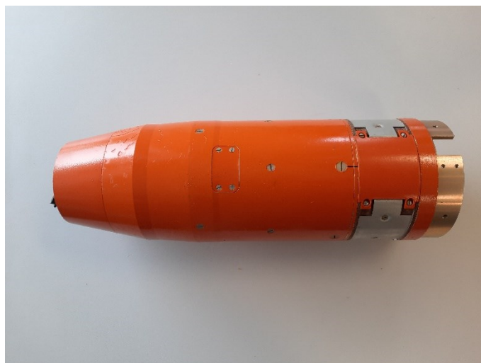
Rys. 3.9. Przedział bojowy ppk, zawierający radiowy moduł telemetryczny. Źródło: opracowanie własne za zgodą MESKO S.A.
