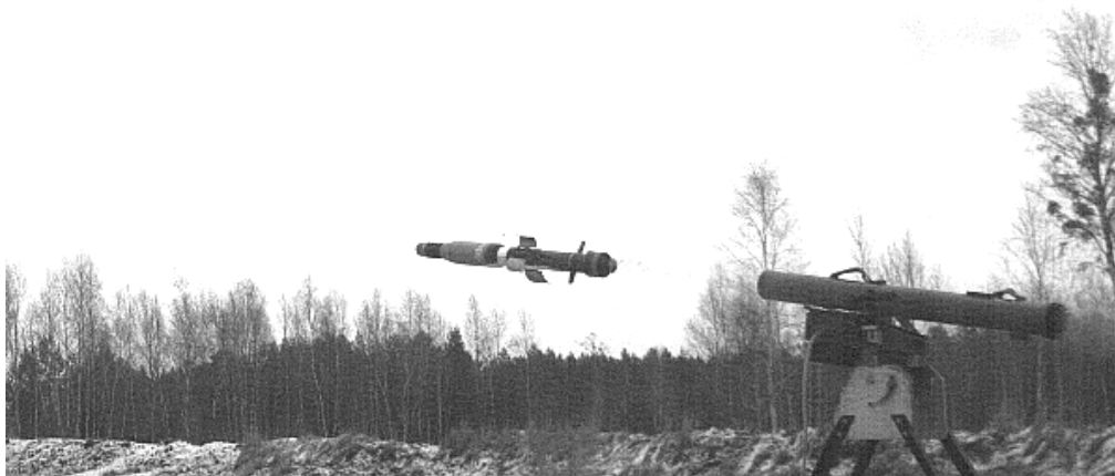
Rys. 10.4. Moment wyjścia ppk z wyrzutni zarejestrowany przez kamerę szybką. Źródło: opracowanie własne za zgodą MESKO S.A.
