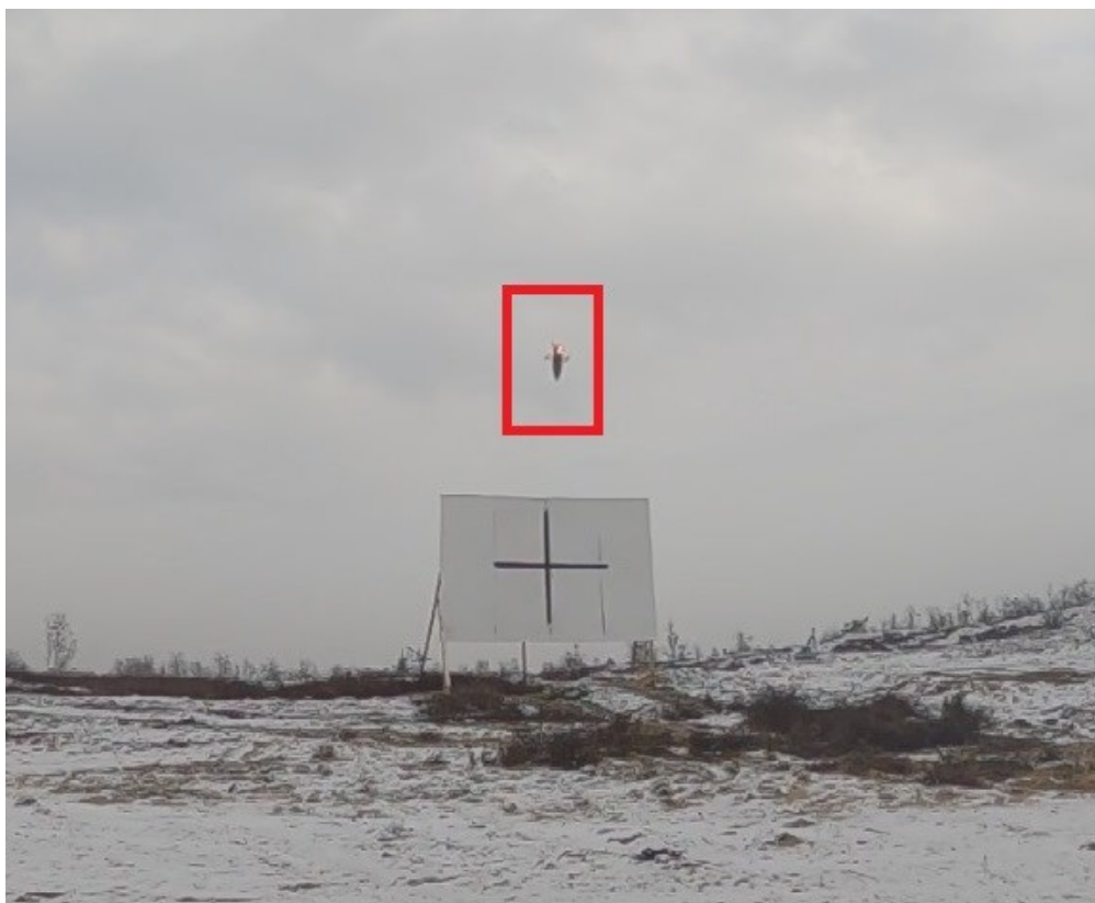
Rysunek 10.14. Pocisk na chwilę przed uderzeniem w tarczę – widok z kamery umieszczonej przed tarczą. Źródło: opracowanie własne za zgodą MESKO S.A.
