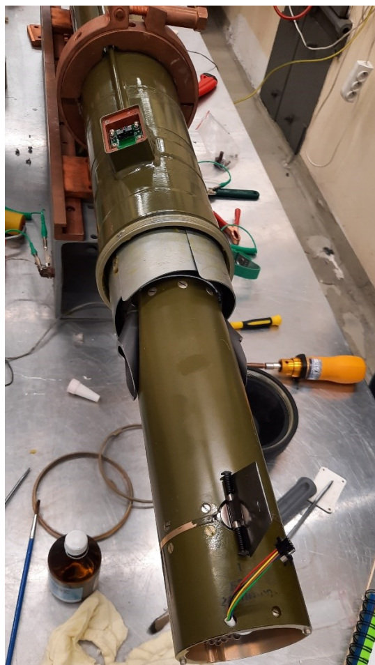
Rys. 9.14. Montaż ppk w pojemniku transportowo-startowym na stanowisku montażowym w zakładach MESKO S.A. Źródło: opracowanie własne za zgodą MESKO S.A.
