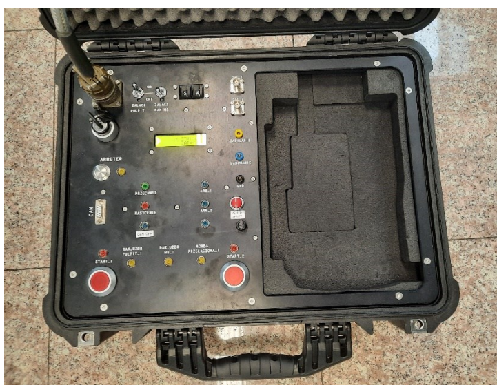
Rys. 3.4. Wynośny pulpit kierowania służący do zdalnego sterowania mechanizmem startowym.
