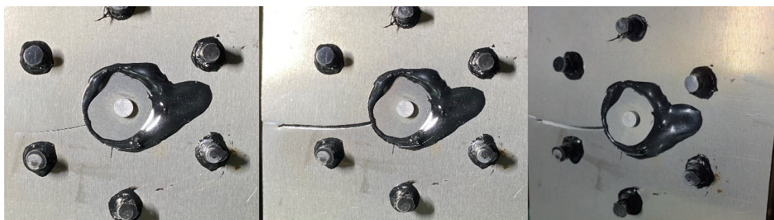
Rysunek 4.19. Zniszczenie zmęczeniowe hybrydowego połączenia nakładkowego (nity MBF2110AB-05-150 i tworzywo Raychem S1125 z warstwą tkaniny Synglass E81)
