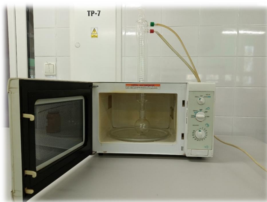
Rys. 18. Własnoręcznie zmodyfikowany aparat do ekstrakcji wspomaganej mikrofalami IGNIS AKL 576/IG/WH
