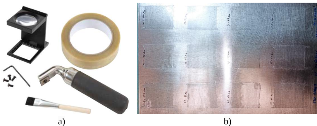
Rys. 5.23 Przygotowanie do badania adhezji, a) Zestaw do badania przyczepności powłoki metodą siatki nacięć, b) próbka do badania przyczepności żywicy epoksydowej
