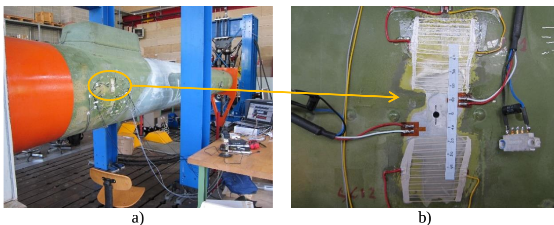
Rys. 4.12 Badanie zmęczeniowe belki ogonowej, a) stanowisko do realizacji testu, b) widok nowych czujników drabinkowych przygotowanych do pracy.
