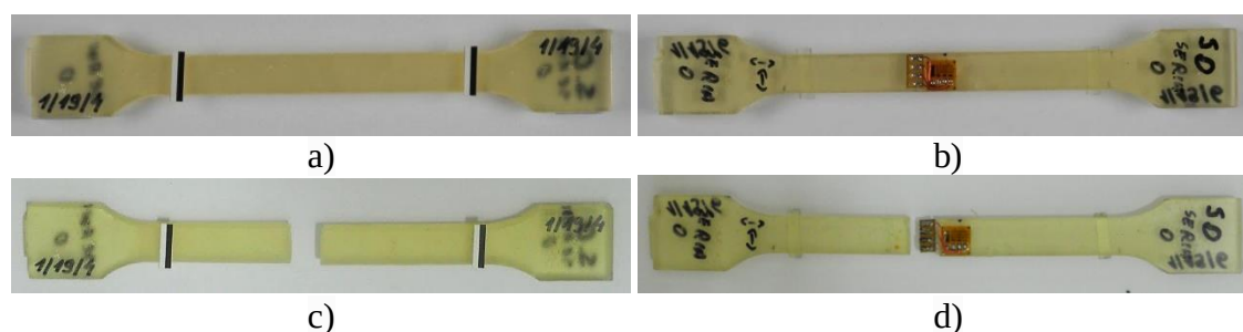
Rys. 5.3 Widok próbki epoksydowej przygotowanej do badań, a) przed zniszczeniem ze znacznikami wideoekstensometru; b) przed zniszczeniem z dodatkowych czujnikiem tensometrycznym; c) i d) te same próbki po zerwaniu
